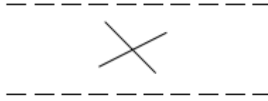
Şekil 2.1 Çapraz çizgi yöntemi ile tarama testi [21]
