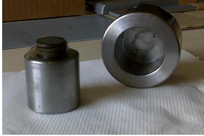
Şekil 3.5. Pul Basma Kalıbı ve Basma Sonrası Numuneler
