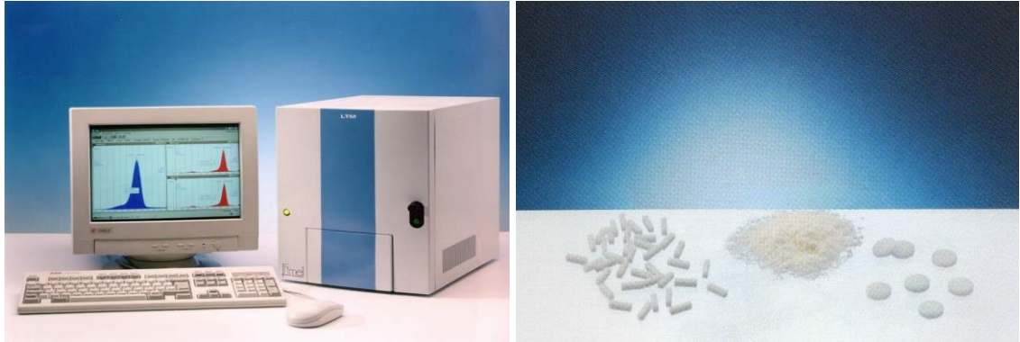
Şekil 3-4: Fimel TLD Sistemi ve Fimel GR-200A Termolüminesans Rodları
