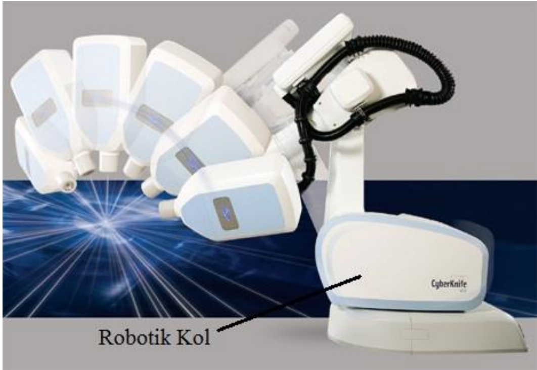
Şekil 2-3: Lineer hızlandırıcının hareketini sağlayan robotic kol
