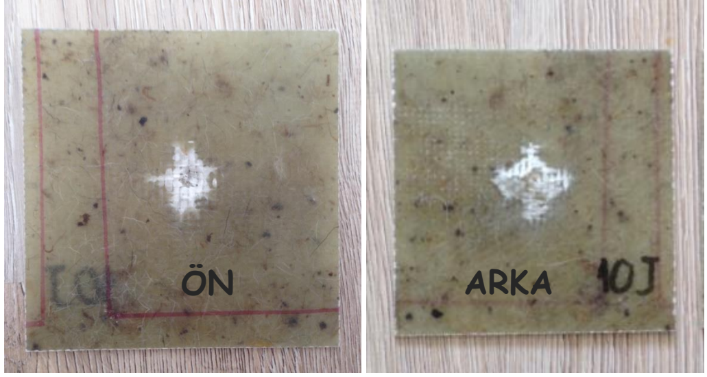
Şekil 3.44 10 J enerji uygulanan sadece keçe takviyeli numune için darbe hasarı fotoğrafları
