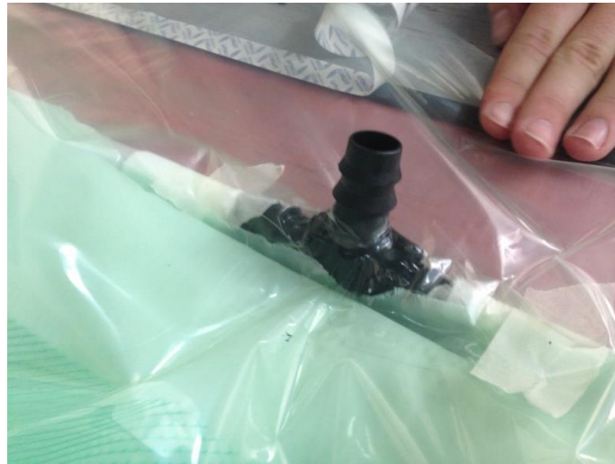
Şekil 2.14 Emme ve basma hortumlarının yalıtılması
