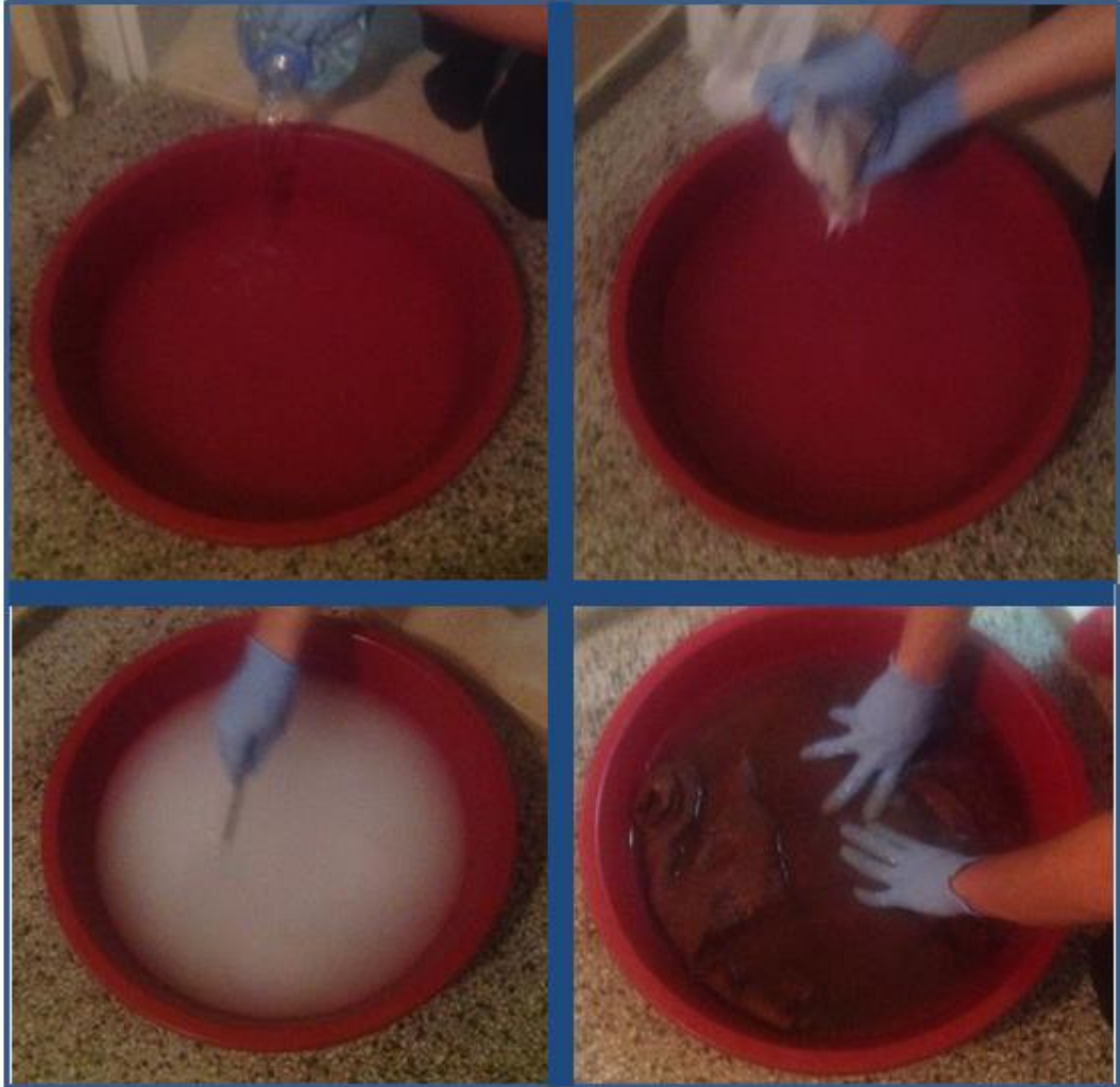
Şekil 2.6 NaOH ile jüt kumaş modifikasyonu
