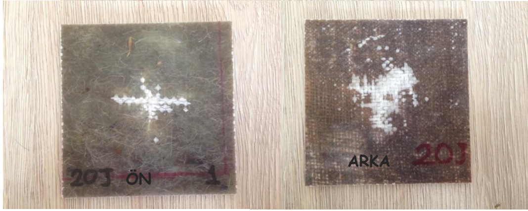
Şekil 3.26 20J enerji uygulanan jüt kumaş/keçe takviyeli numune için darbe hasarı fotoğrafları
