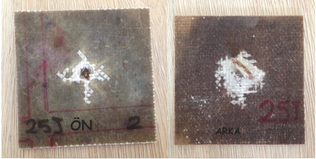
Şekil 3.29 20J enerji uygulanan jüt kumaş/keçe takviyeli numune için darbe hasarı fotoğrafları
