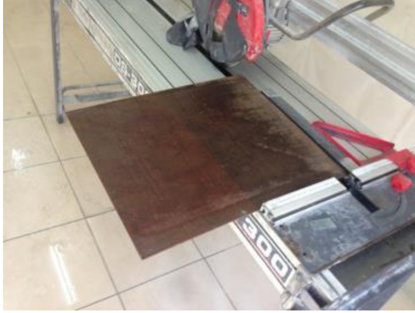
Şekil 2.20 Kompozitlerin uygun boyutlarda kesimi
