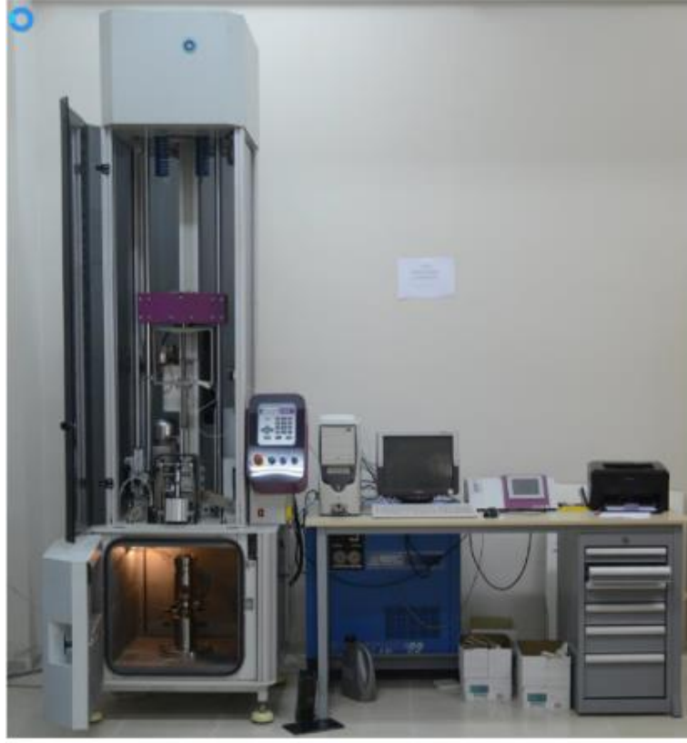
Şekil 3.7 Ceast-Fractovis Plus darbe cihazı
