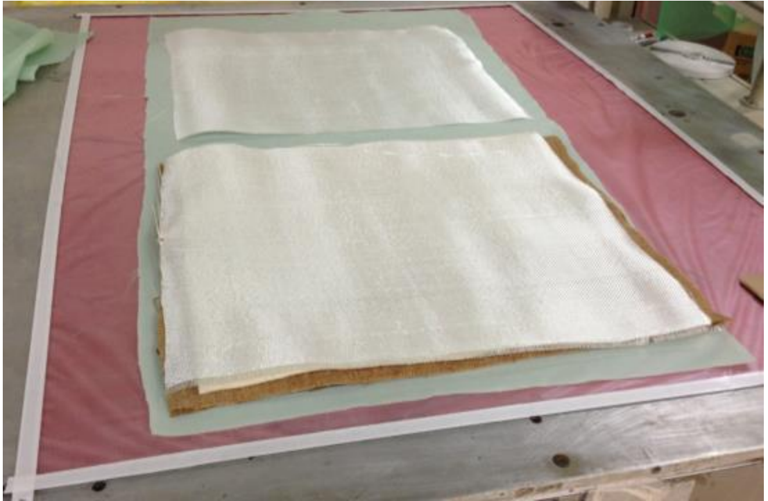
Şekil 2.10 Kumaşların üst üste sıralanması
