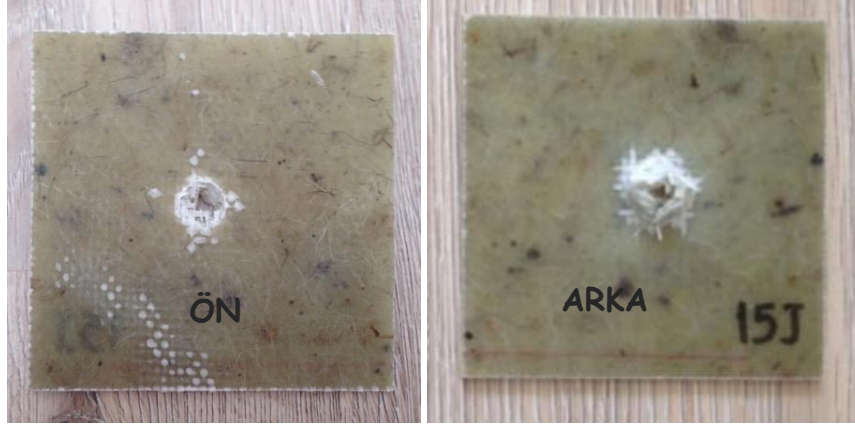
Şekil 3.47 15J enerji uygulanan sadece keçe takviyeli numune için darbe hasarı fotoğrafları
