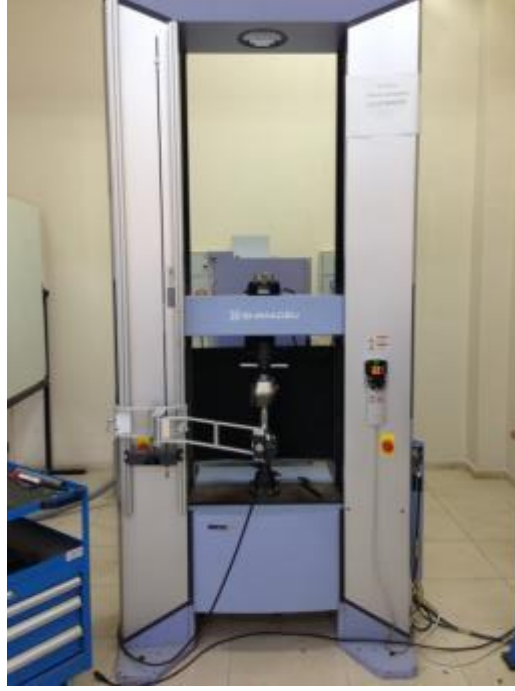
Şekil 3.1 Shimadzu çekme testi cihazı
