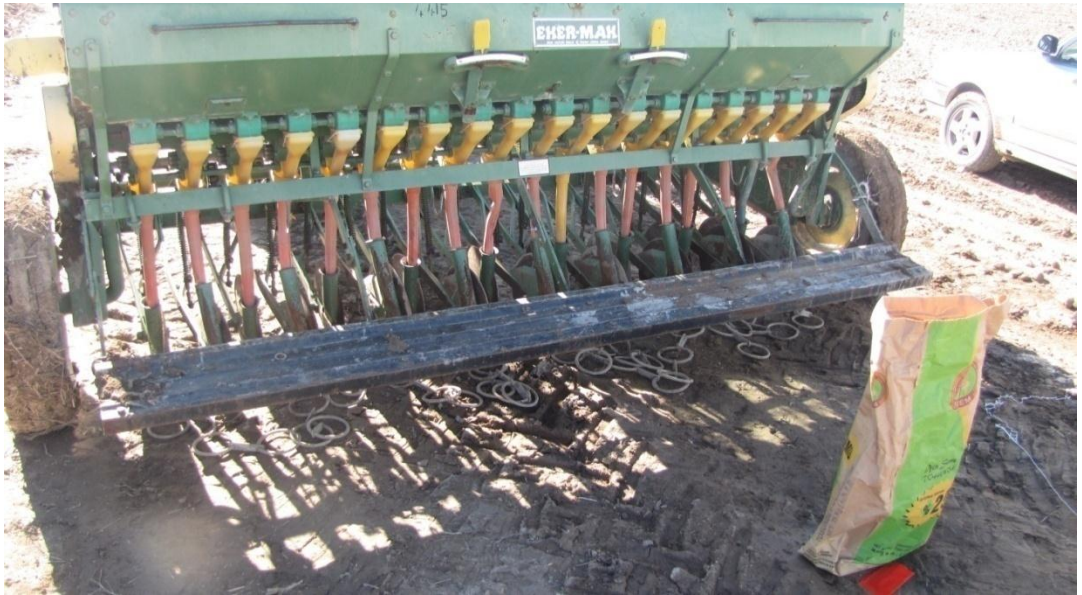
Şekil 3.20 Standart miktarda tohum ve gübre atabilen mibzer
