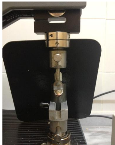
řekil 3-26 Instron Cihazında Basma Tipi Dayanım Testinin Uygulanması
