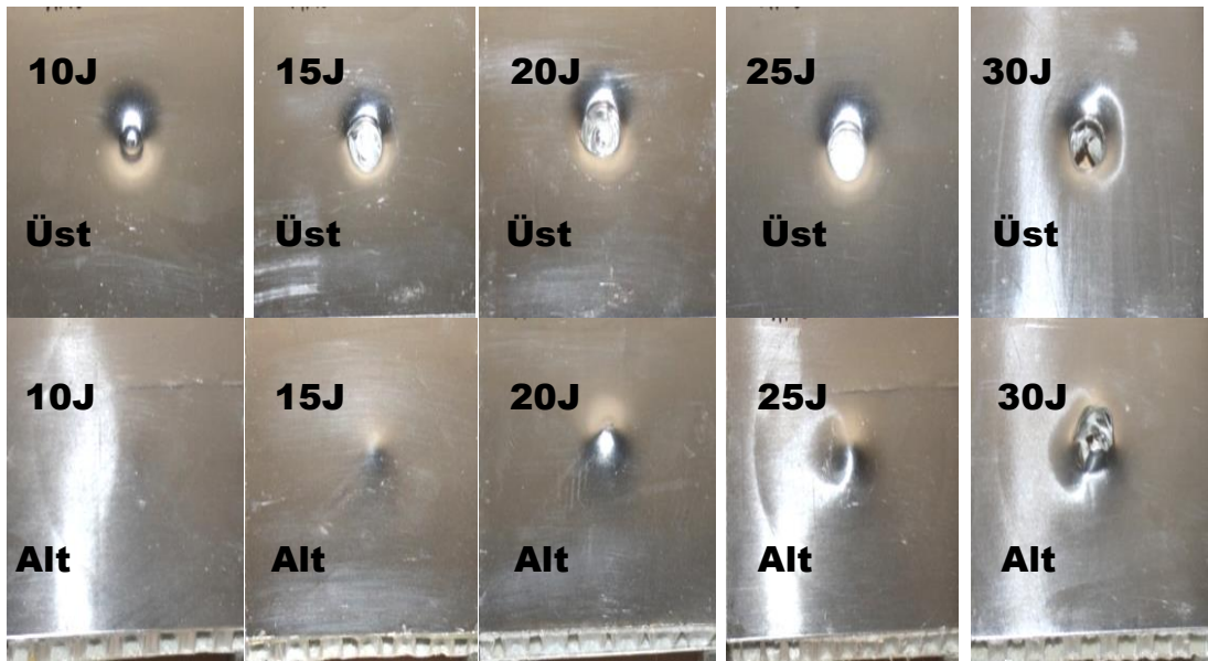
Şekil 5.9. Farklı enerji seviyeleri için bal petekli sandviç yapıya ait kuvvet-deplasman eğrisi ile üst ve alttan çekilmiş hasar resimleri
