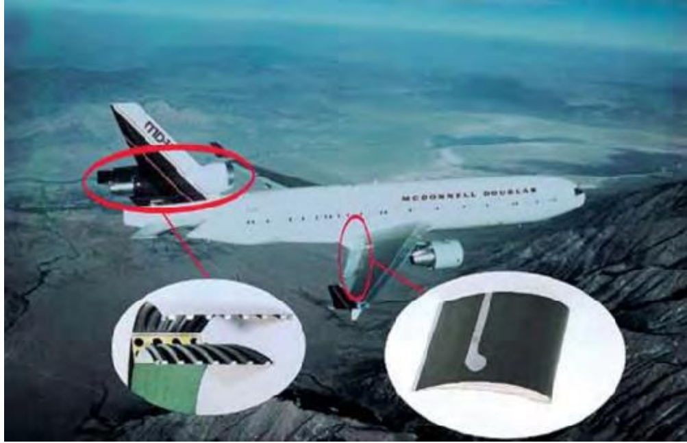
Şekil 2.17. Uçak teknolojisinde kullanılan kompozit malzemeler
