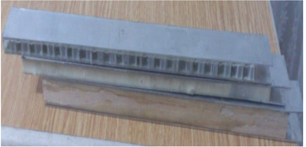
Şekil 3.2. Farklı kalınlıklarda ve farklı çekirdekli sandviç nümüneler (titreşim testi için)
