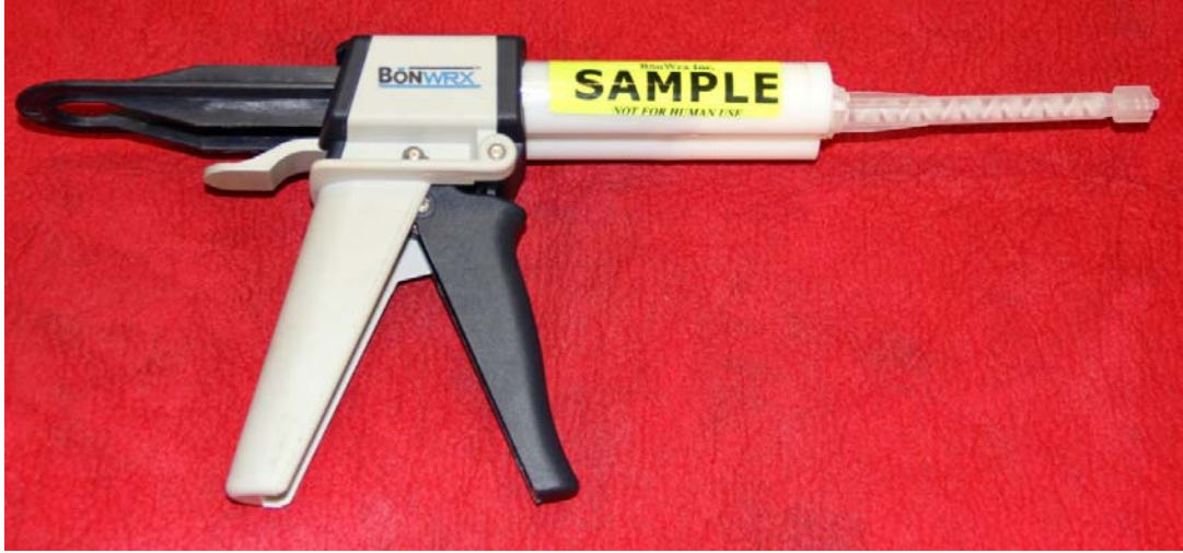
Şekil 2.4. Özel sıkma aparatına takılmış VK100 polimeri.
