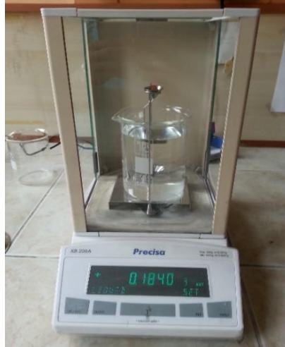
Şekil 4.6 : Hassas terazi ve Arşimet düzeneği.
