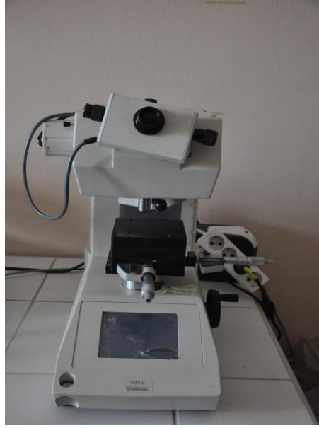
Şekil 4.5 : Shimadzu marka HMV model mikro sertlik cihazı [58].
