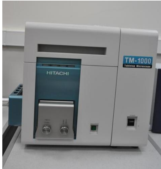
Şekil 4.4 : Hitachi TM1000 masaüstü taramalı elektron mikroskobu [57].
