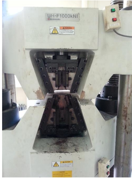
Şekil 4.7 : Shimadzu marka çekme testi cihazı.
