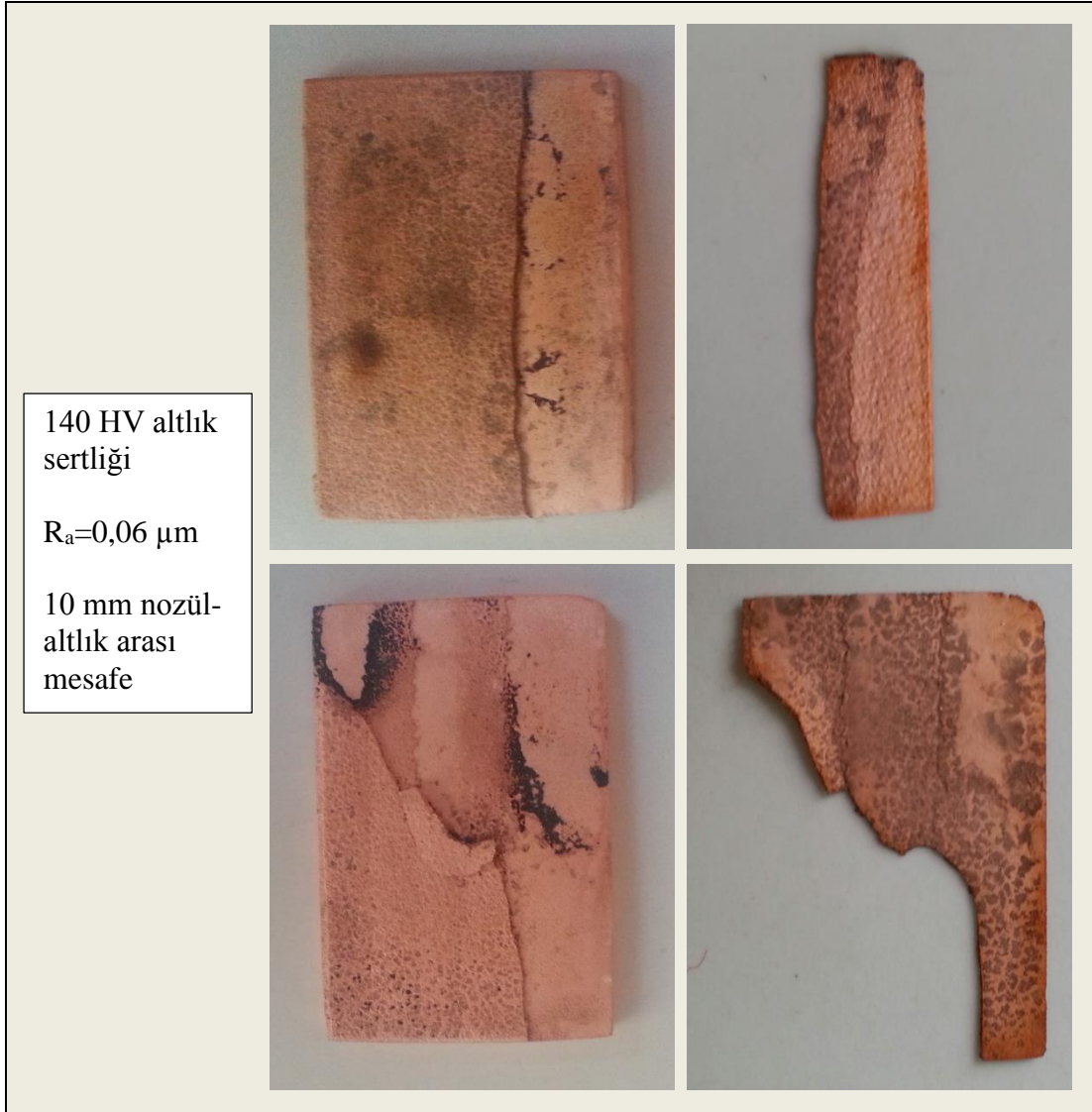
Şekil 5.20 : Yapışma mukavemeti sonrası altlık malzeme ve üstünde kalan kaplamanın (sol taraf) ve kaplamadan kopan (sağ taraf) parçaların makro fotoğrafları.
