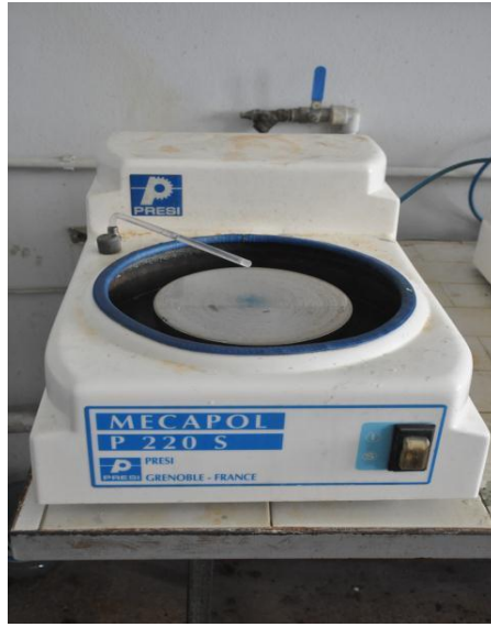
Şekil 4.1 : MECAPOL marka zımparalama ve parlatma cihazı [55].
