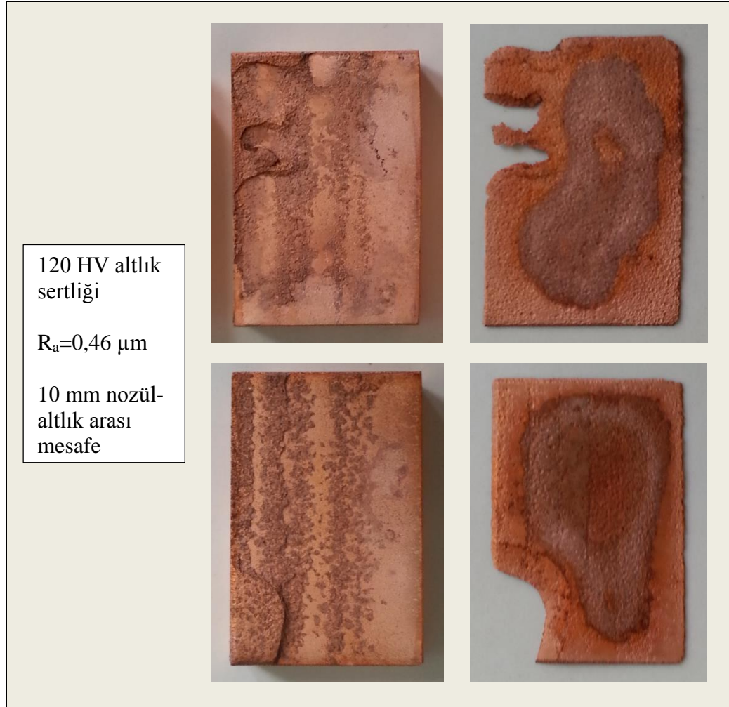
Şekil 5.25 : Yapışma mukavemeti sonrası altlık malzeme ve üstünde kalan kaplamanın (sol taraf) ve kaplamadan kopan (sağ taraf) parçaların makro fotoğrafları.
