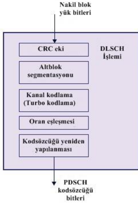
Şekil 4.6. Nakil-kanal işleme yapısı
