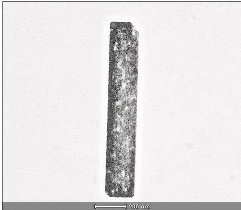
Resim 4.15. Altı aylık stabilite çalışması süresinin sonunda +4°C'de saklanan, insülin nanokohleat formülasyonlarının TEM görüntüleri x30000
