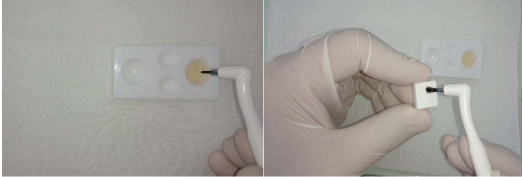
Şekil 3.13b Primer A-B'nin PZ örnek yüzeyine uygulanması
