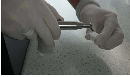
Şekil 3.5 c- Cojet işlemi uygulanması
