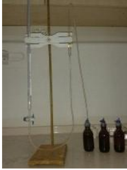
Şekil 3.10. Metan gazı ölçümü (sıvı yer deęiřtirme prensibine göre)
