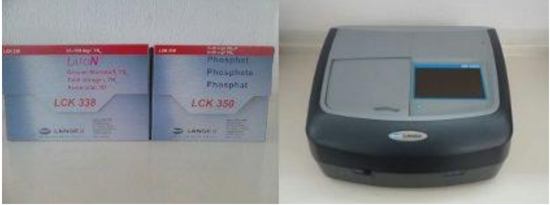
Şekil 3.7. Lange marka TN ve TP hücre kitleri ve Lange DR 6000 marka spektrofotometre
