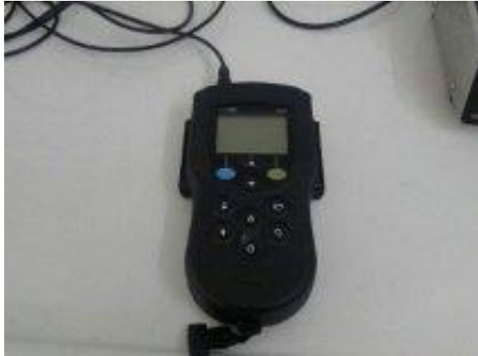
Şekil 3.6. Çalışmalarda kullanılan HQ40d marka iletkenlik ölçüm cihazı
