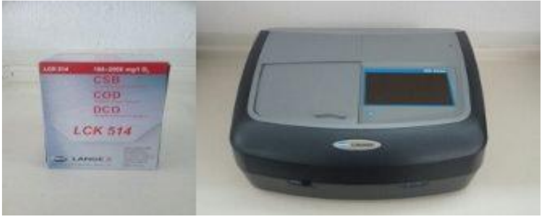
Şekil 3.8. Lange marka KOİ hücre kitleri ve Lange DR 6000 marka spektrofotometre
