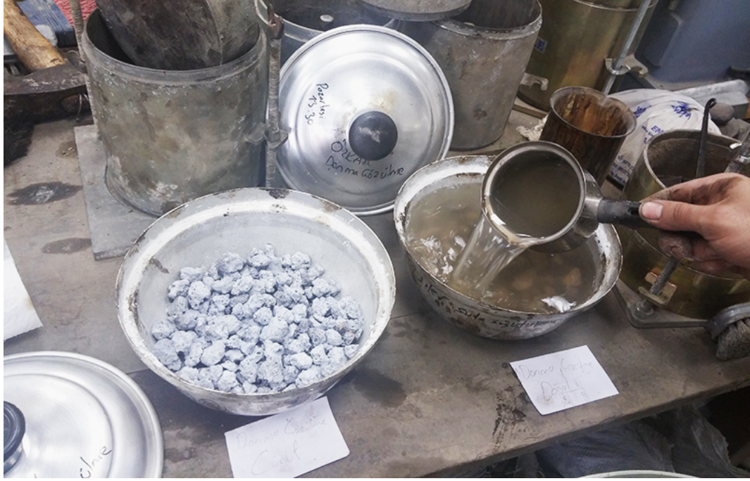
Şekil 6.5: Kurutulan agregaya magnezyum sülfat çözeltisi eklenmesi.
