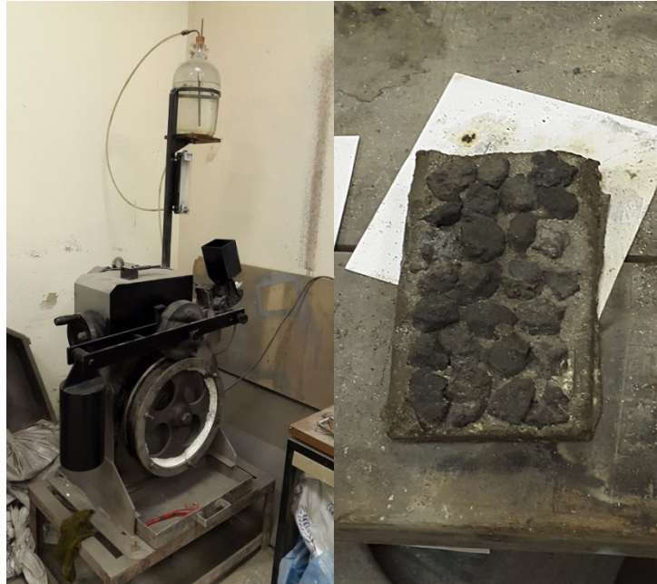
řekil 6.7: Cilalanma test makinası ve cilalanma numunesi.
