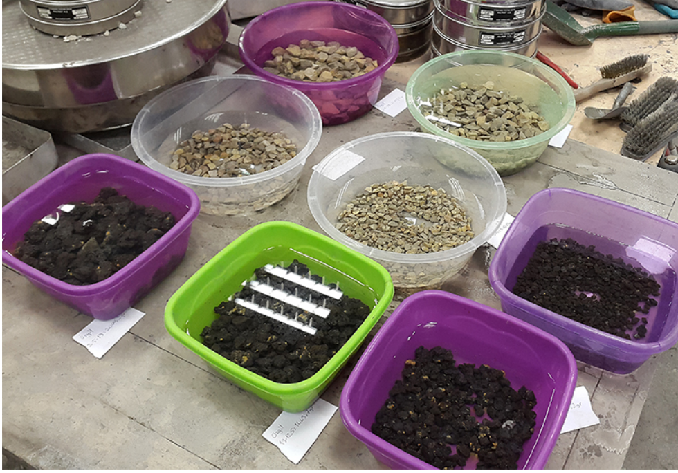
Şekil 6.2: Agregaların su içerisinde bekletilerek doymun hale getirilmesi.
