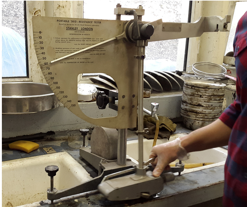
Şekil 6.8: Cilalanma deneyi sürtünme test cihazı.
