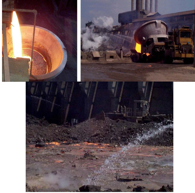
Şekil 4.9: Yüksek fırın cürufunun soğutulması [62].
