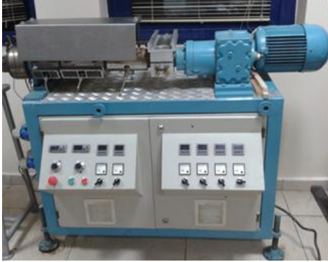
Şekil 3.6 Tek vidalı ekstruder makinesi ve su banyosu ve üretilen kompozit materyaller
