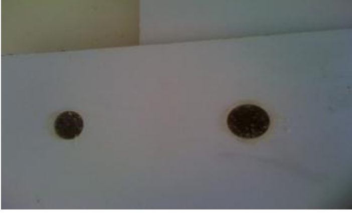
Şekil 4.6 Laminat kaplı polimer kompozitlerin yapışma direnci testi sonrası durumu
