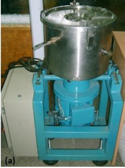
Şekil 3.5 Polimer kompozit üretiminde a) karıştırıcı b) kırıcı
