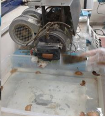
Şekil 3.6 Tek vidalı ekstruder makinesi ve su banyosu ve üretilen kompozit materyaller
