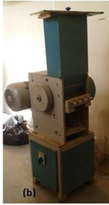
Şekil 3.5 Polimer kompozit üretiminde a) karıştırıcı b) kırıcı
