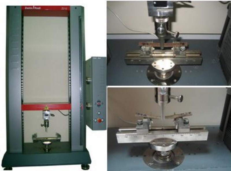
Şekil 3.13 Zwick/Roell Z010 universal test makinesi ve eğilme direnci
