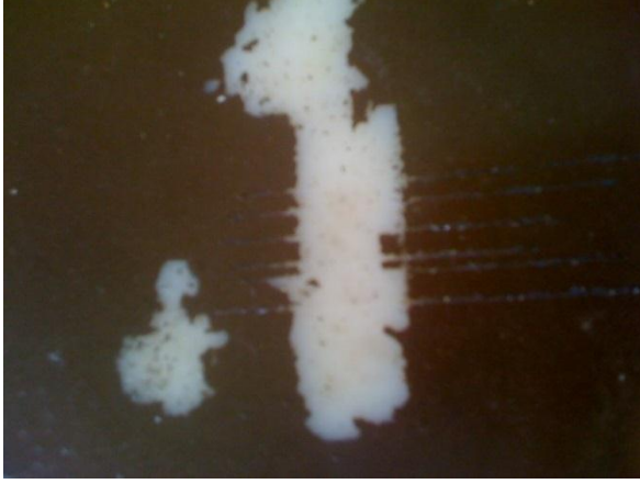
Şekil 4.5 Örneklerin çapraz kesimle yapışma deneyi sonrası durumu (0A sonucu)
