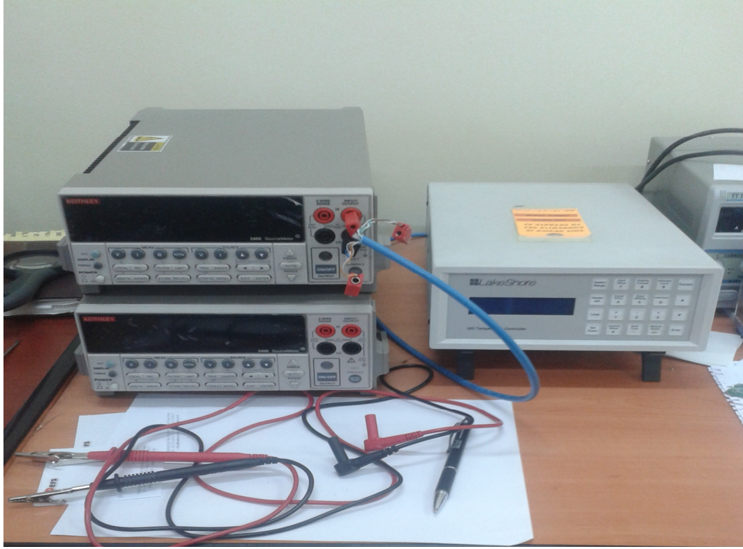
Resim 3.7. Akım-gerilim ölçümlerinde kullanılan Keithley 2400 Sourcemeter ve Lakeshore 325 sıcaklık kontrol cihazları
