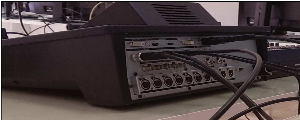
Resim 2.9: Panasonic AG-HMX100 Görüntü Mikseri SDI Girişleri
