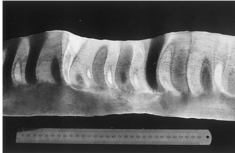
Şekil 3.13: AA 1200 şerit için bir kenar dalgası örneği [39].
