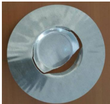
Şekil 5.9: Şekillendirme sonrasında 0,20 mm H19 alüminyum levhaların görünümleri (çizgiler hadde yönü göstermektedir)
