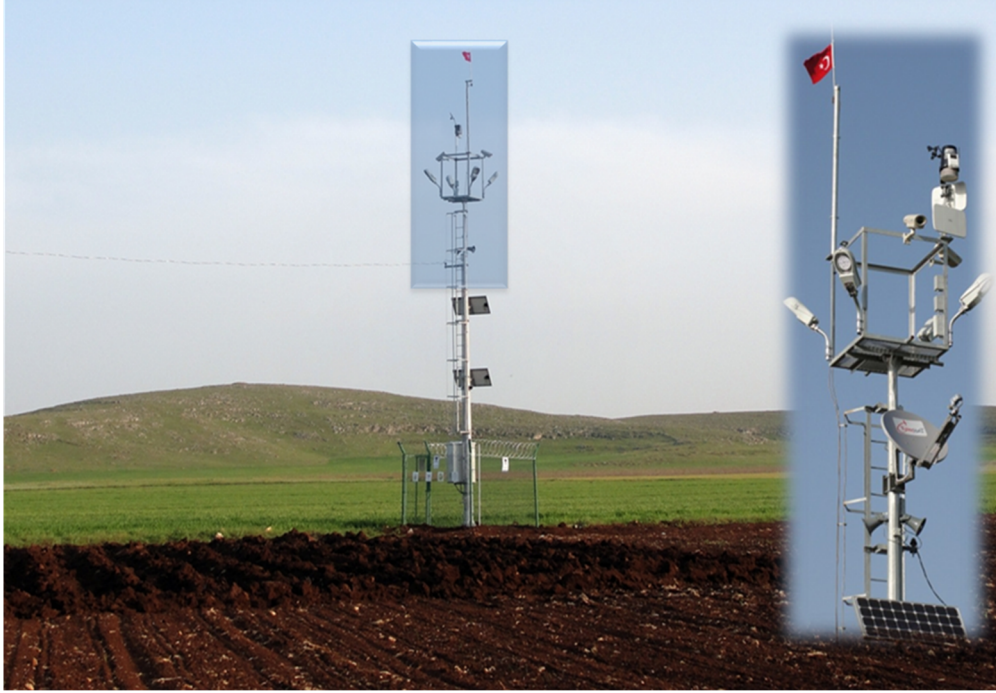
Şekil 3.2 : Yer gözlem istasyonu ve bileşenleri.
