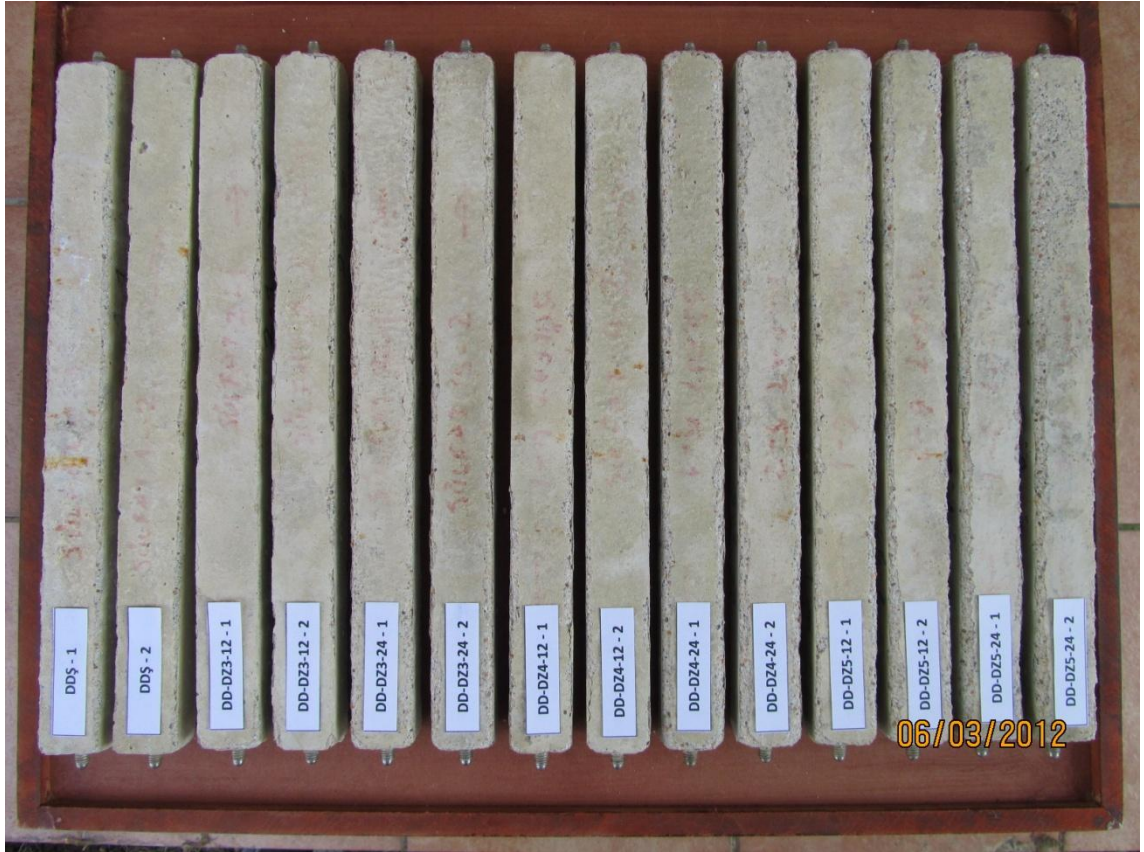
Şekil 5.16: Harç prizmalarının sülfat hasarı deneyi tamamlandıktan sonraki durumu
