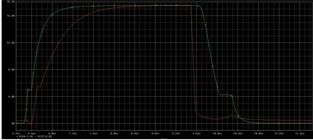
Şekil 5.7: Gecikme işaretlerini gösteren simülasyon sonucu.
