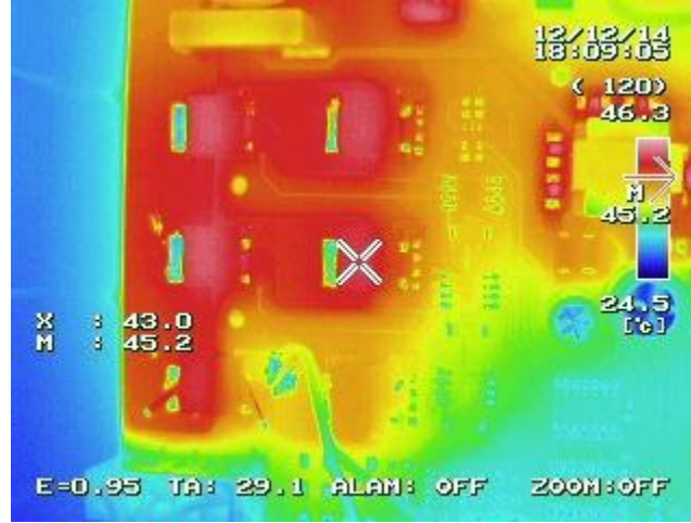
Şekil 5.3: GaN tabanlı anahtarlama elemanları için sıcaklık ölçümü.
