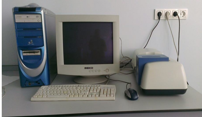
Şekil 3.24. Analytic Jena Speedcord S600 model UV-Vis spektrofotometre (Gültekin, 2013)
