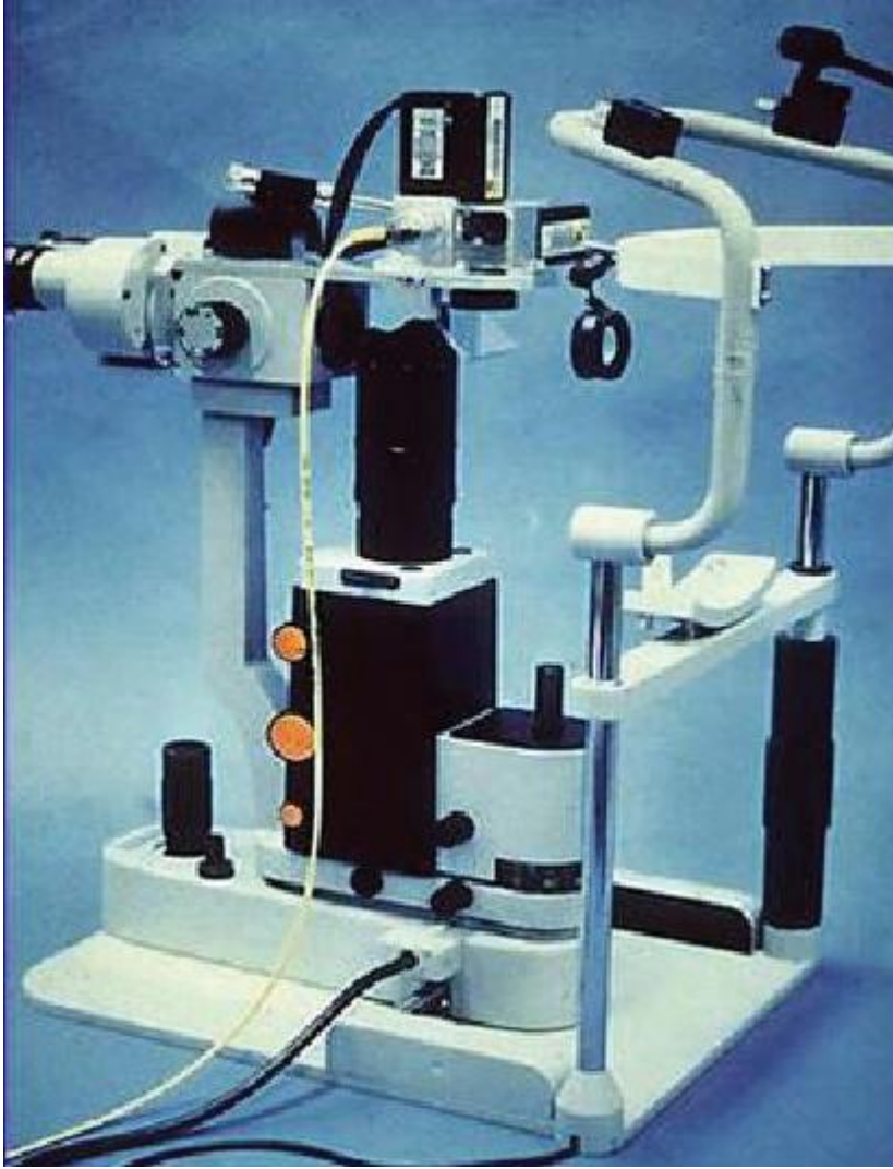
Şekil 2.2: Prototip OKT; biyomikroskop üzerine yerleştirilmiş bir süperluminesent diod laser cihazı ve bunun bağlandığı, referans aynasını da içeren bir interferometreden oluşmaktaydı.
