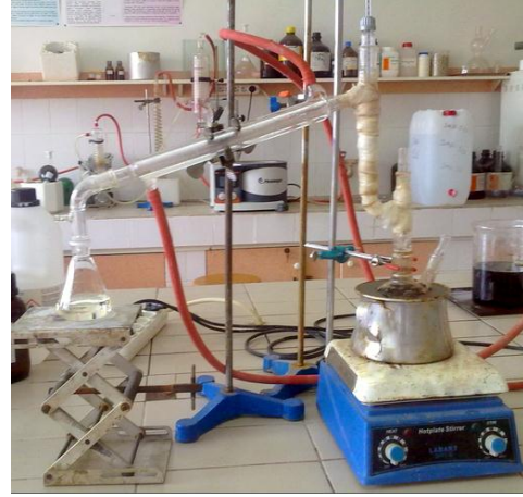
Şekil 5.2. Geri soğutucuya bağı yağ banyosu deney düzeneğı Şekil 5.3. Mikro damıtma deney düzeneğı
