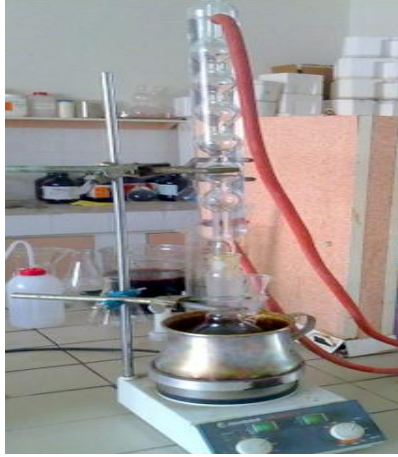
Şekil 5.2. Geri soğutucuya bağı yağ banyosu deney düzeneğı Şekil 5.3. Mikro damıtma deney düzeneğı
