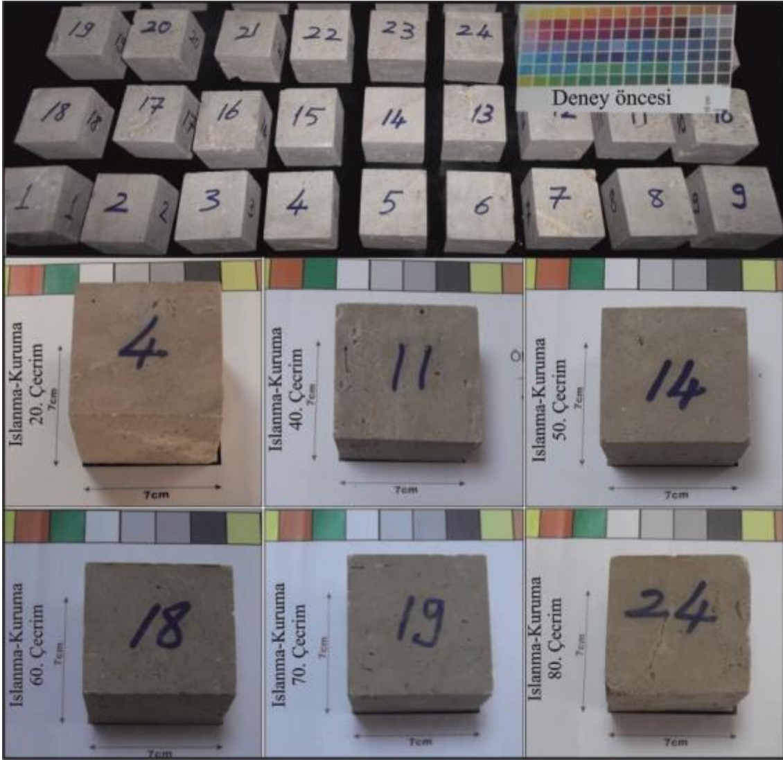
Şekil 4.62. Islanma-kuruma deneyi öncesi ve sonrasına ait Trv1 türü numunelerin görünümü.
