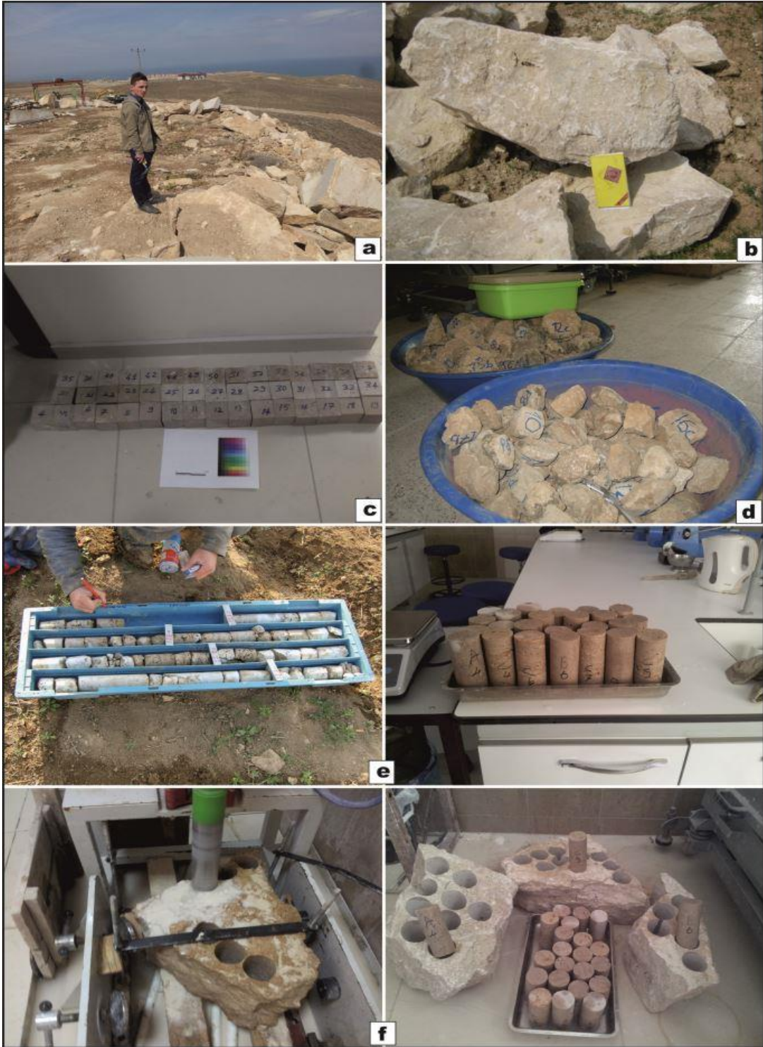
Şekil 3.11. Fiziko-mekanik özellikler ve yapay bozunma deneyleri için alınan örnekler. (a, b): blok örnekler ve alındıkları mermer ocağı, (c): 7x7x7 cm boyutundaki küp örnekler, (d): Düzensiz şekilli el örnekleri, (e): Sondajlardan elde edilen silindirik numuneler, (f): Blok örneklerden elde edilen silindirik numuneler.
