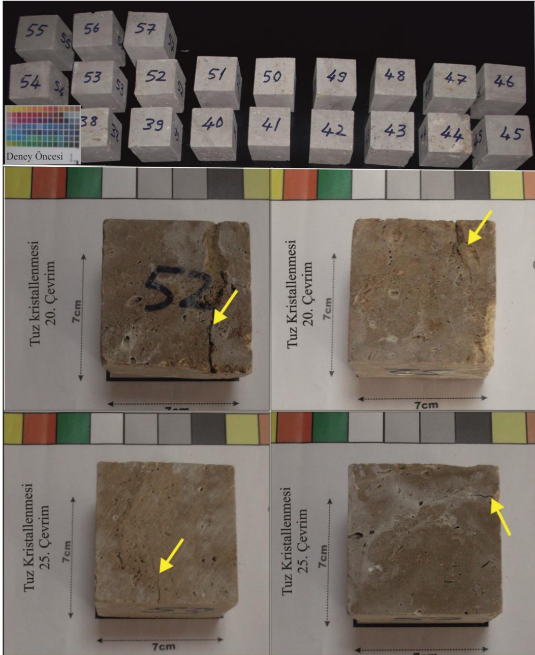
Şekil 4.66. Tuz kristallenmesi etkisi ile traverten örneklerinde meydana gelen bozunmalar.
