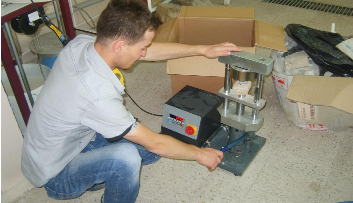
Şekil 3.14. Nokta yükü dayanım indeksi deneyinin yapılışı.
