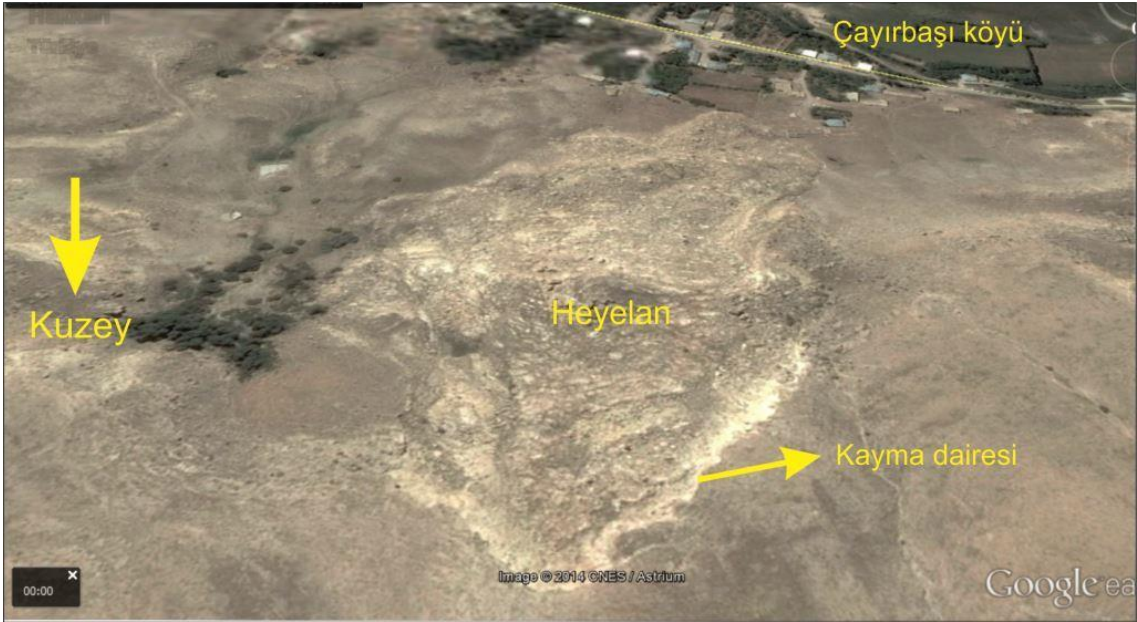
Şekil 4.43. Çayırbaşı köyü mevkindeki heyelana ait uydu görüntüsü (ölçeksiz Google Earth görüntüsü).
