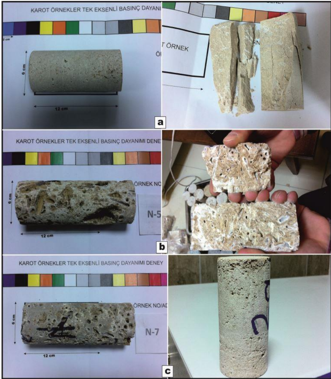
Şekil 4.50. Silindir şekilli numunelerin tek eksenli basınç dayanımı deneylerine ait görüntüler. (a)Trv1 türü (b) Trv3 türü ve (c) Trv2 türü traverten örneklerinin deney öncesi ve sonrasına ait görüntüler.
