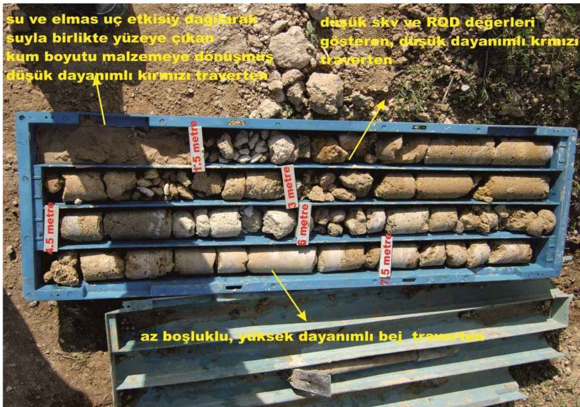
Şekil 4.19. Düşük dayanımlı kırmızı renkli travertende yapılan sondaj ilerlemesine ait bir görüntü.
