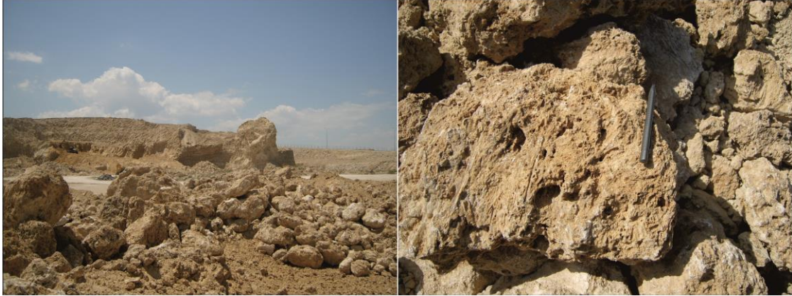
Şekil 4.20. Çalışma alanında yer alan düşük dayanımlı travertenlerin bozunmasıyla oluşan seviyeler (Çimento fabrikası ocağı mevki).
