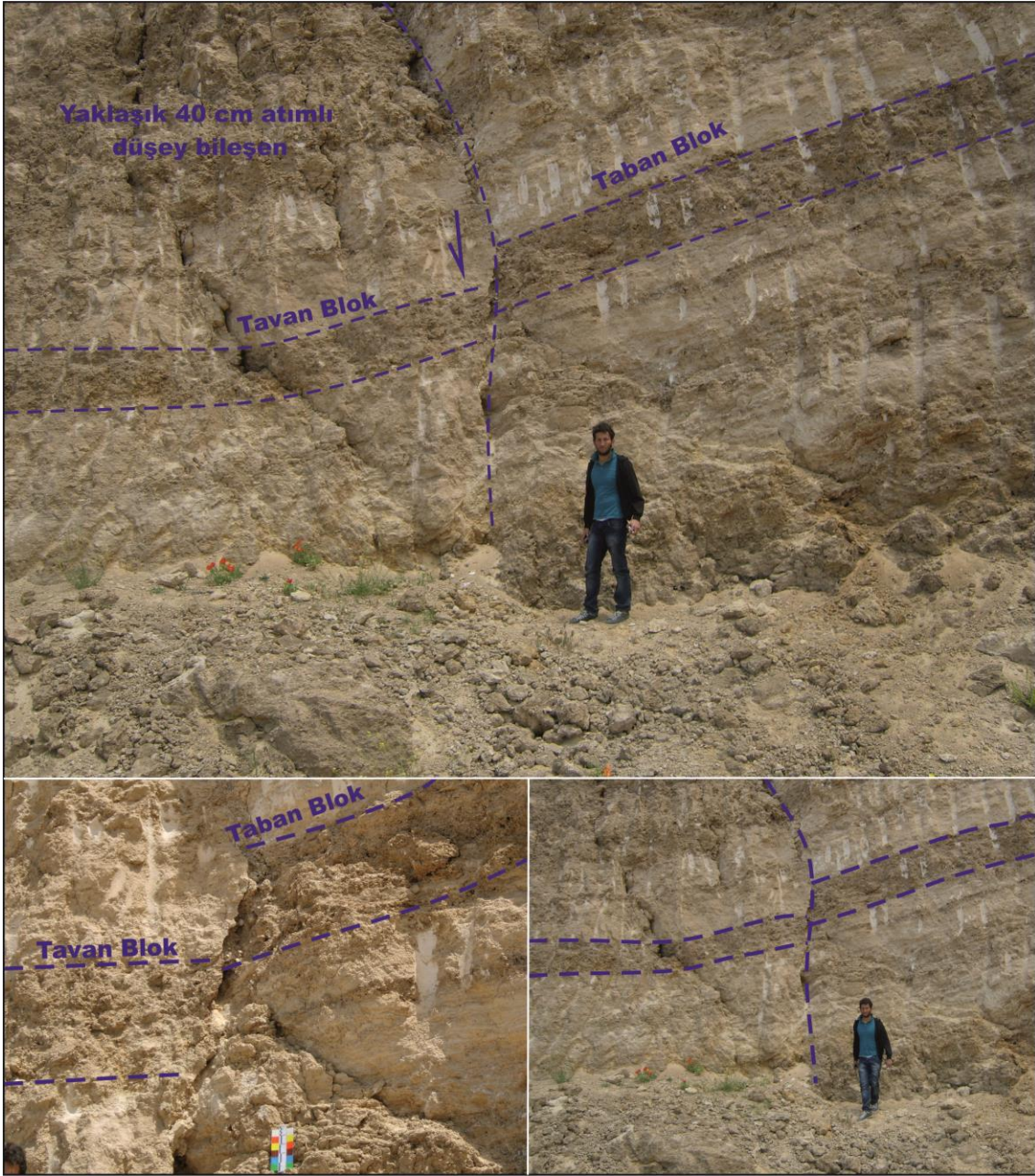
Şekil 4.39. Çimento fabrikası ocağında gözlenen K10D/82KB yönelimli normal bileşenli sağ yönlü fay, yaklaşık 35 cm lik bir düşüm mevcut (bakış yönü kuzeydoğu).
