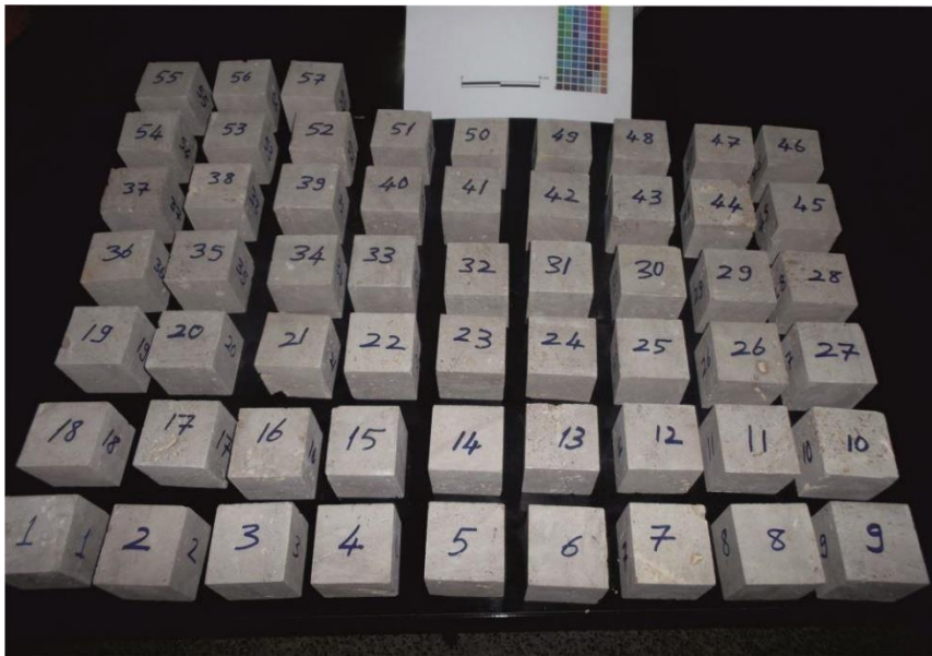
Şekil 3.21. Yapay bozunma deney için hazırlanan küp traverten numuneleri.
