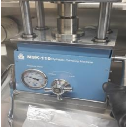
Şekil 2.11. a) Jeton pilin hidrolik sistemde birleştirilmesi ve b) birleştirilen örnek piller.
