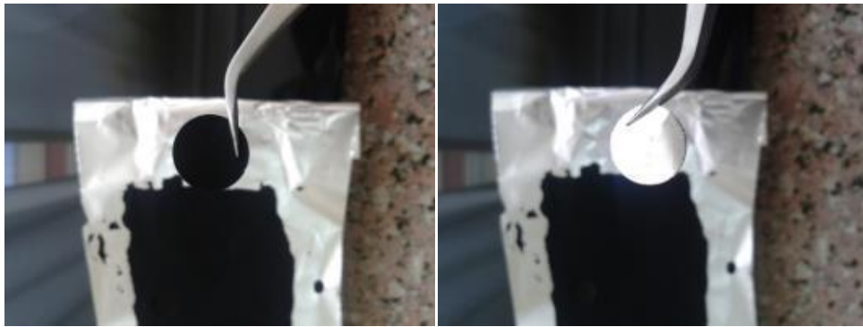
Şekil 2.7. (a) Alüminyum folyo üzerinde kurutulmuş katot malzemesinin disk kesme makinesi ile kesilmesi ve (b) kesilen parçanın ön ve (c) arka yüzleri.
