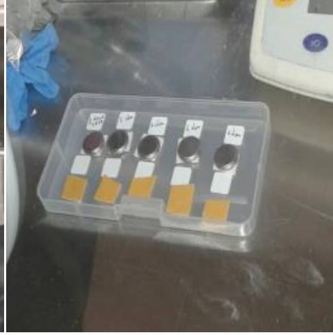
Şekil 2.11. a) Jeton pilin hidrolik sistemde birleştirilmesi ve b) birleştirilen örnek piller.
