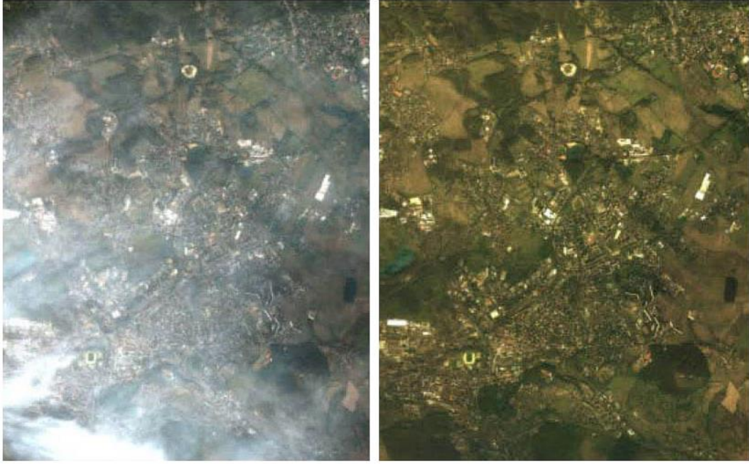
Şekil 3.2 SPOT-7 görüntüsü (Soldaki görüntü Atmosferik düzeltmesi yapılmamış, sağdaki görüntü atmosferik düzeltmesi yapılmış)
