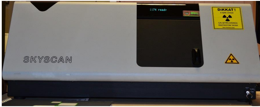
Resim 3.19. SkyScan 1174 mikro tomografi cihazı
