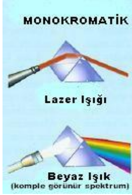
Şekil 2.4. Monokromatik lazer ışığı ve polikromatik beyaz ışık [91]
