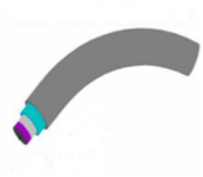
Şekil 2.8. Çok katmanlı esnek hollow tüp [91]
