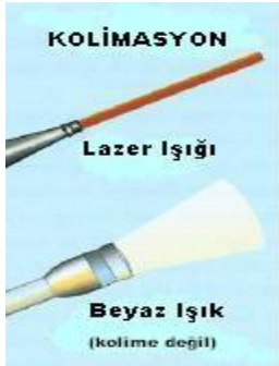
Şekil 2.5. Kollime lazer ışığı ve kollime olmayan beyaz ışık [91]
