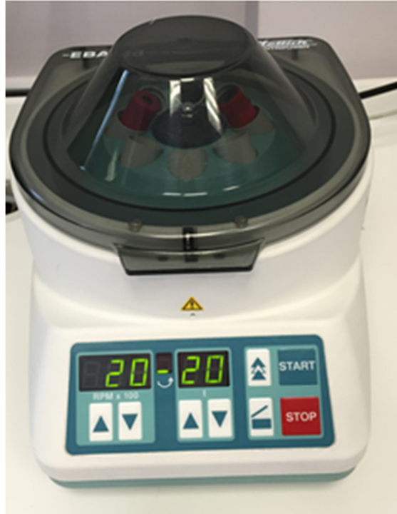
Şekil 10. Örneklerin 2000x rpm’de 20 dakika santrifüj edilmesi.
