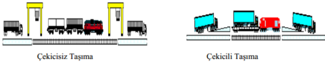
Şekil 3.1 : Çekicisiz ve çekicili taşıma sistemleri [10].
