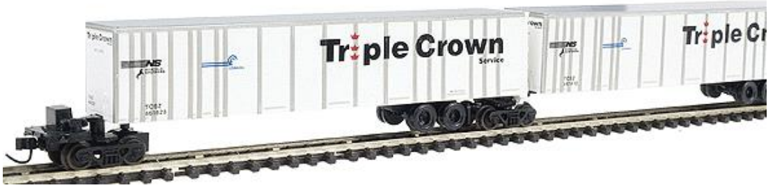
Şekil 3.2 : Bi-modal taşımacılıkta römork (Raodrailer) bağlantısı.
