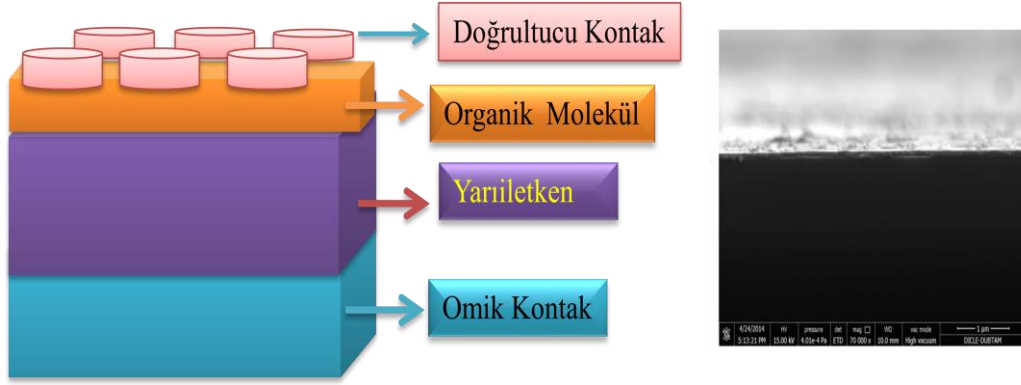
Şekil 4.6. Al/ KS/p-Si diyotunun şematik gösterimi ve SEM fotoğrafı.
