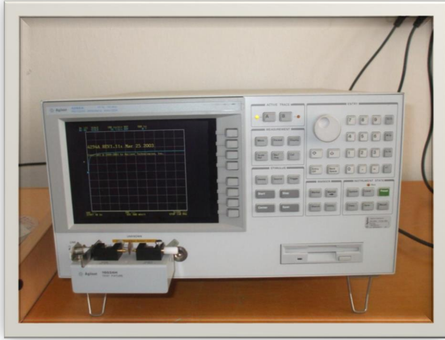
Şekil 4.8. C - V ölçümünde kullanılan HP 4294A impedans analizör cihazı.
