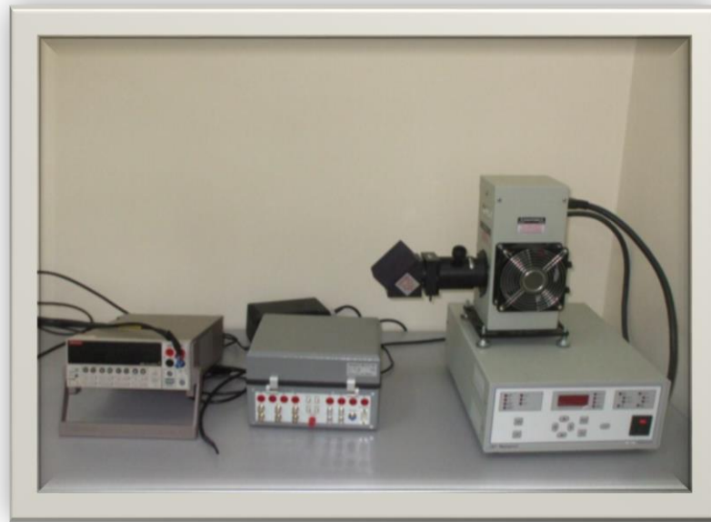
Şekil 4.7. Işık altı I - V ölçümünde kullanılan voltaj kaynağı ve solar simülasyon cihazı.
