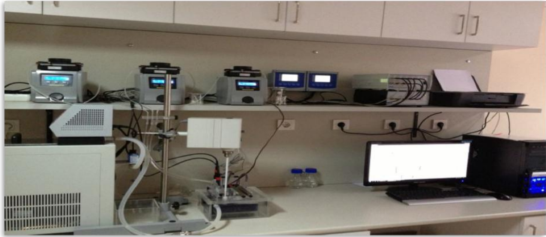
Şekil 3.3 EC ile atık su arıtım sisteminin fotoğrafı
