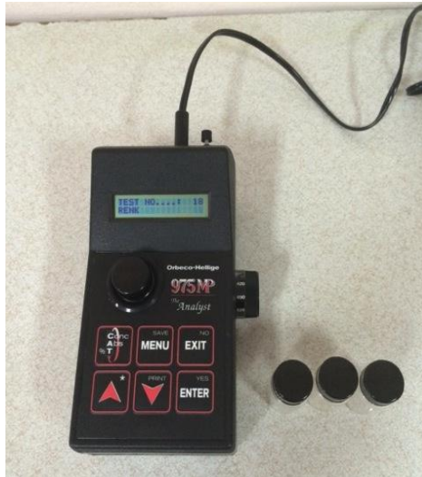
Şekil 3.4 Renk ve Bulanklık tayini için kullanılan su analiz sistemi (Technical Bulletin ORBECO- HELLIGE / The Model 975-MP portable Water Analysis System)
