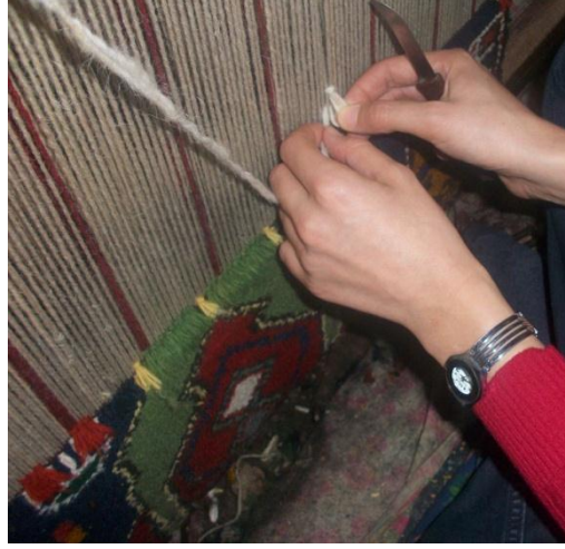
Şekil 6. Havlı Yüzeyin Oluşturulması
