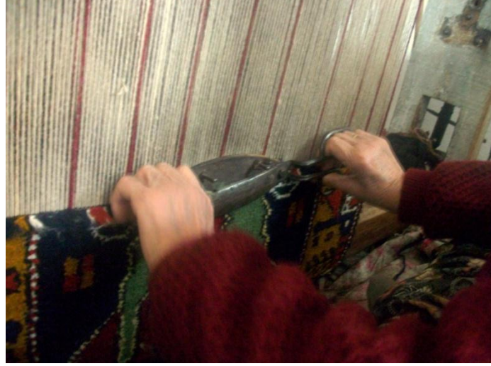
Şekil 10. Hav Kesim İşlemi
