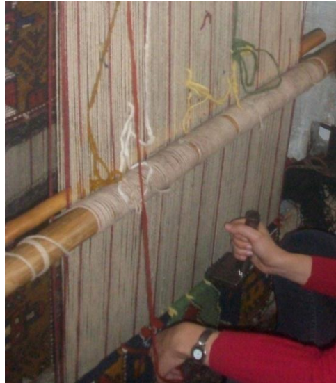
Şekil 9. İlmeleri Yerleştirmek İçin Halının Kirkitlenmesi
