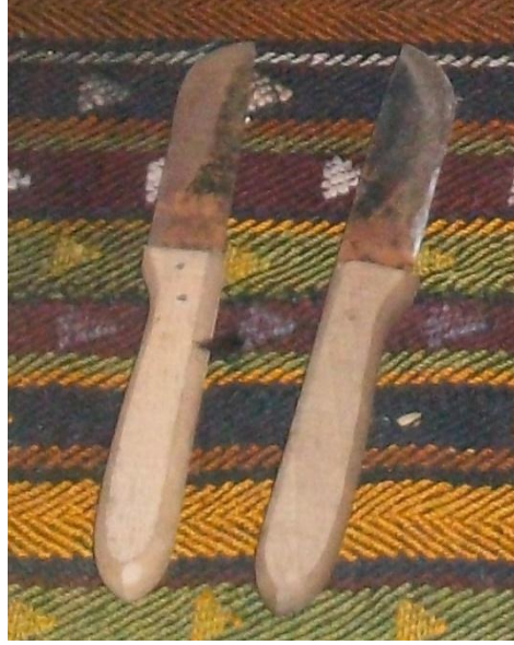
Şekil 4. İlme İpliklerinin Kesiminde Kullanılan Bıçak
