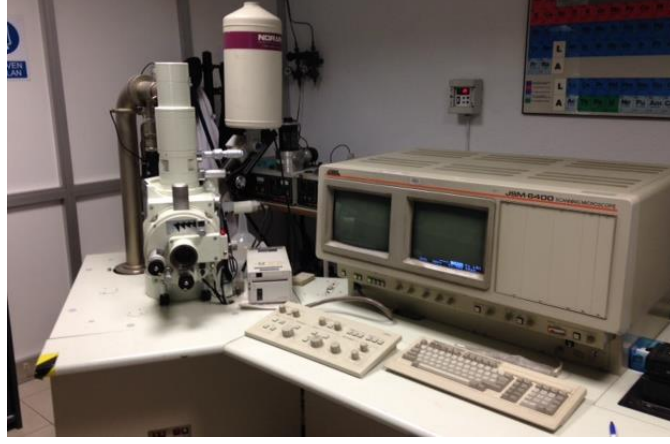
Şekil 4.10: JOEL marka JSM 6400 model taramalı elektron mikroskobu.
