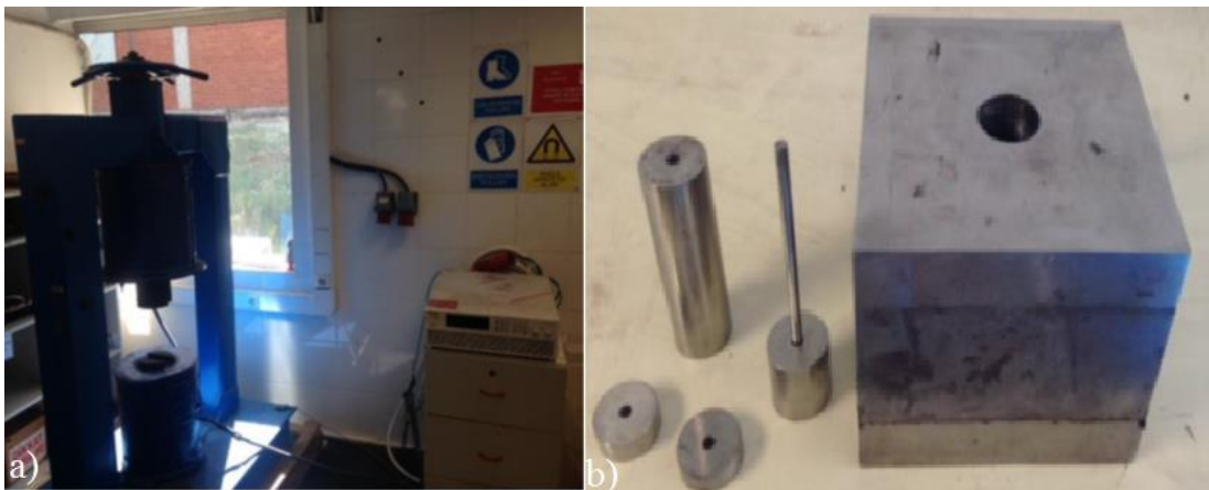
Şekil 4.7: a) Anizotropik pres cihazı, b) Basma kalıbı.
