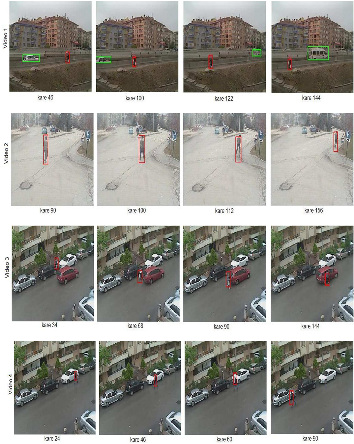
Şekil 5.3. 4 farklı video dizisi için WTA kodları üzerinden tanımlanan mesafe ölçütüne dayalı izleme sonuçları
