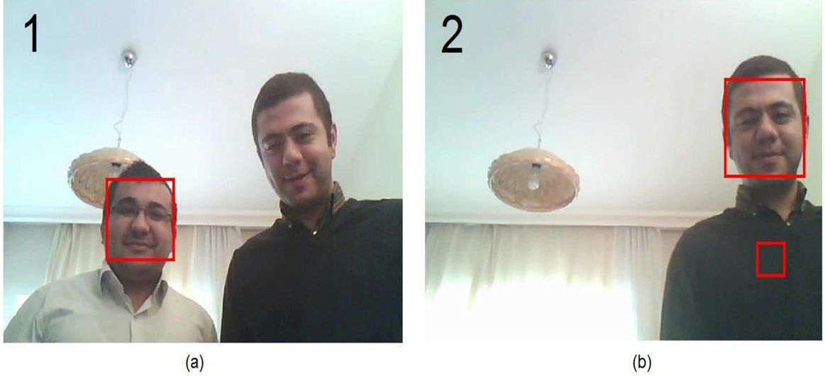
Şekil 3.10. Sadece kamera kullanımı ile yüz saymada karşılaşılan (a) yanlış negatif ve (b) yanlış pozitif örnekleri
