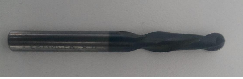
Şekil 3.13. Ara Kaba işlemede kullanılan 10 mm çaplı takım
