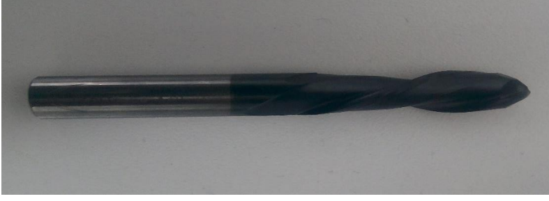
Şekil 3.13. Ara Kaba işlemede kullanılan 10 mm çaplı takım
