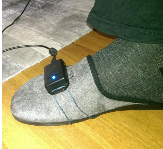
Şekil 3.25: 3-Space sensor ünitesinin adım takibi deneyi için ayak üzerine konumlandırılması.
