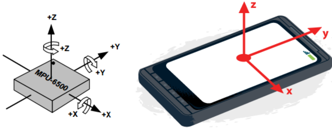
Şekil 3.3: MPU-6500 entegresi koordinat eksenleri gösterimi ve akıllı telefon üzerine konumlandırılması.
