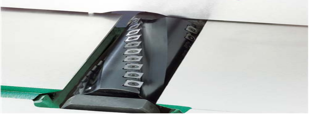
Şekil 2.9. Planya makinesi kesici bloğunda bıçakların helisel olarak yapılandırılması ve parçalı kesici kullanımı
