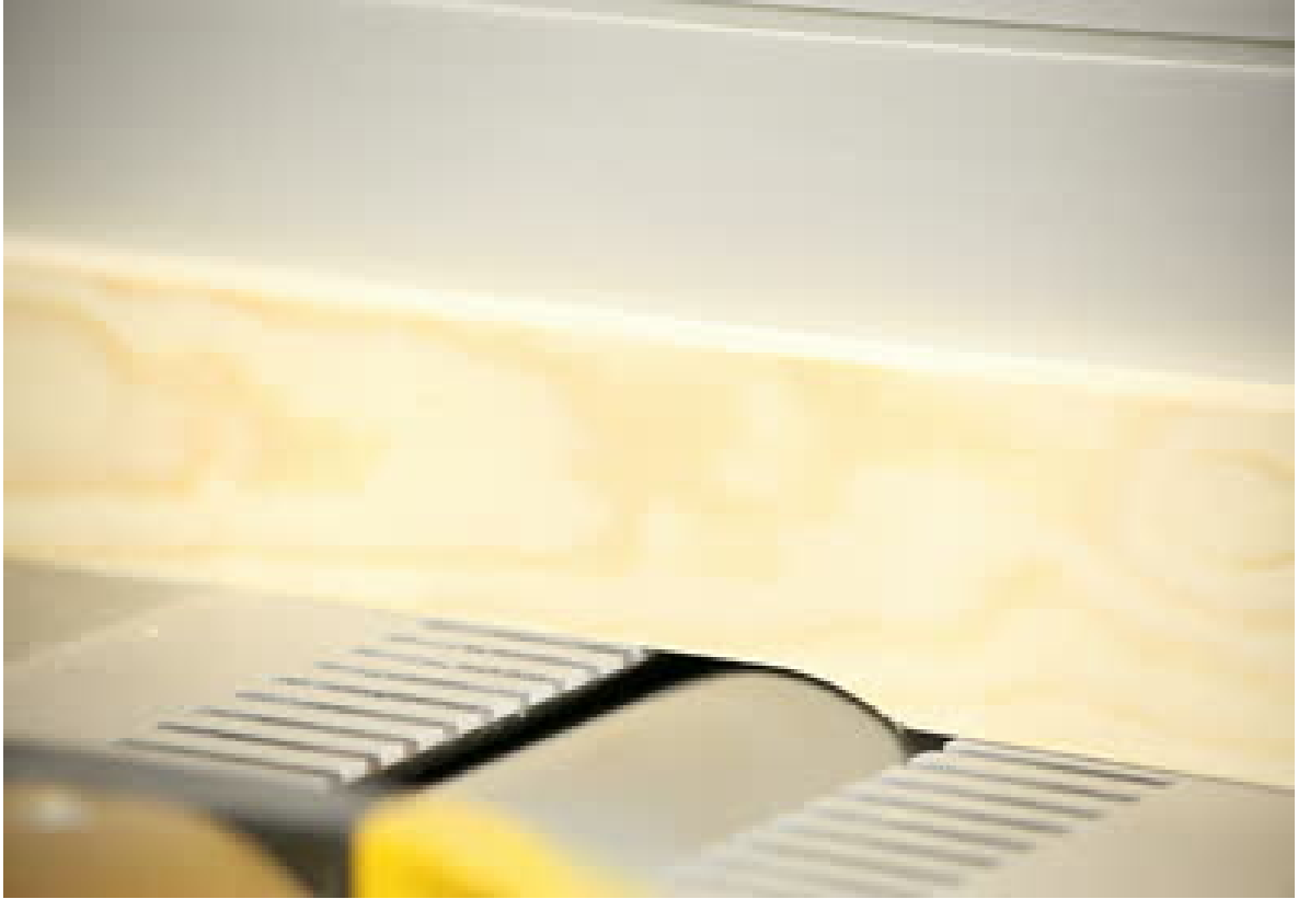
Şekil 2 8. Planya makinesinin ön ve arka tablalarının kesici tarafı kenarlarında kanallı yapı
