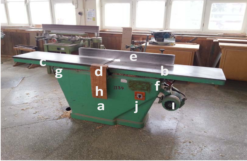
Resim 3.1. Planya makinesinin yapısal elemanları: a) Gövde, b) Ön tabla, c) Arka tabla, d) Mil ve bıçaklar, e) Siper, f) Ön tabla ayar kolu, g) Arka tabla ayar kolu, h) Koruyucu, ı) Motor, j) Şalter
