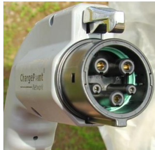
Şekil 2.1 : Tip 1 şarj kablosu konektörü [30].
