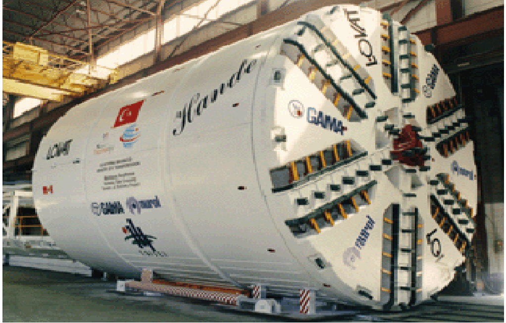
Şekil 2.6: Marmaray projesinde kullanılan EPB-TBM (Öztürk ve Durmuş,2008).
