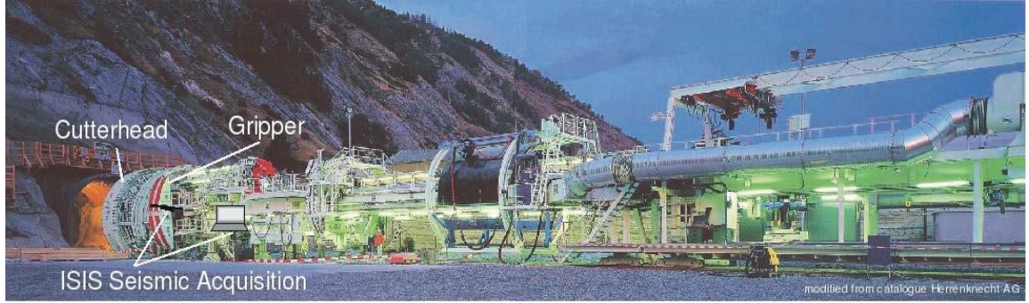
Şekil 2.8: Bir gripper TBM ile birlikte sismik veri toplama gösterilmiştir. ISIS: Birleşmiş Sismik Görüntüleme Sistemi GFZ- Postdam tarafından geliştirilmiştir (Kneb, Kassel ve Lorenz, 2000).
