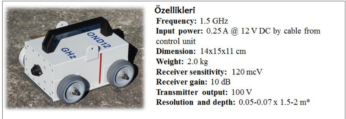
Şekil 4.1: Saha ölçümlerinde kullanılan Yapı Radarı ekipmanı ve özellikleri ( http://www.radsys.lv/en/products-soft/products/prod/9 )
