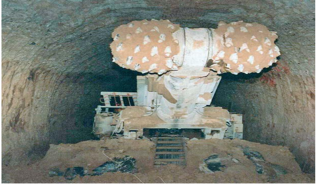
Şekil 2.9: Kazı yapan kollu tünel açma makinesinden bir görünüm (Şahkulubey, 2008)
