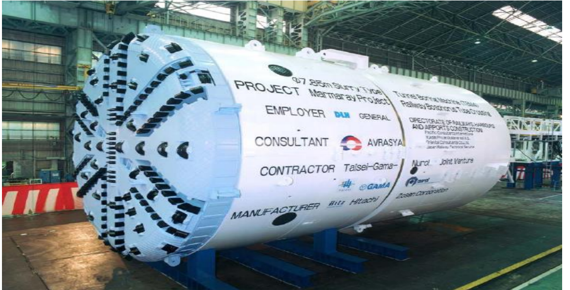
Şekil 2.5: Marmaray projesinde kullanılan 1. Çamur Şildi (Slurry TBM) ( www.marmaray.com.tr ).
