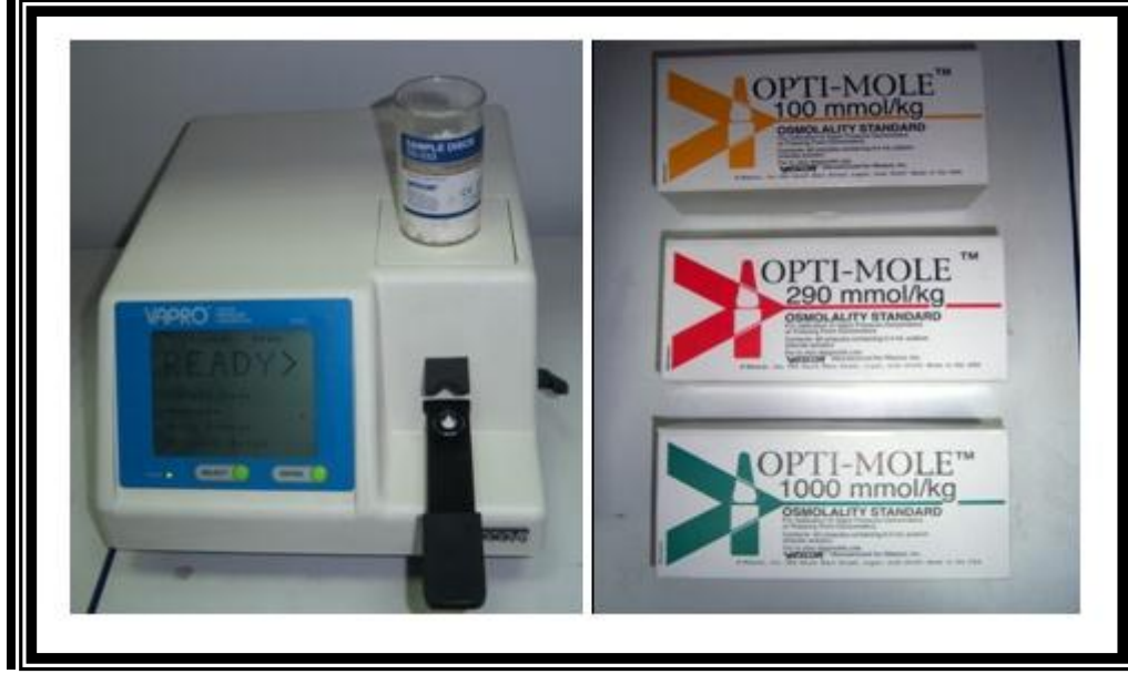
Şekil 3.3 Viescor marka Vapro (Vapor Pressure Osmometer) 5520 model osmometre cihazı ve standartları
