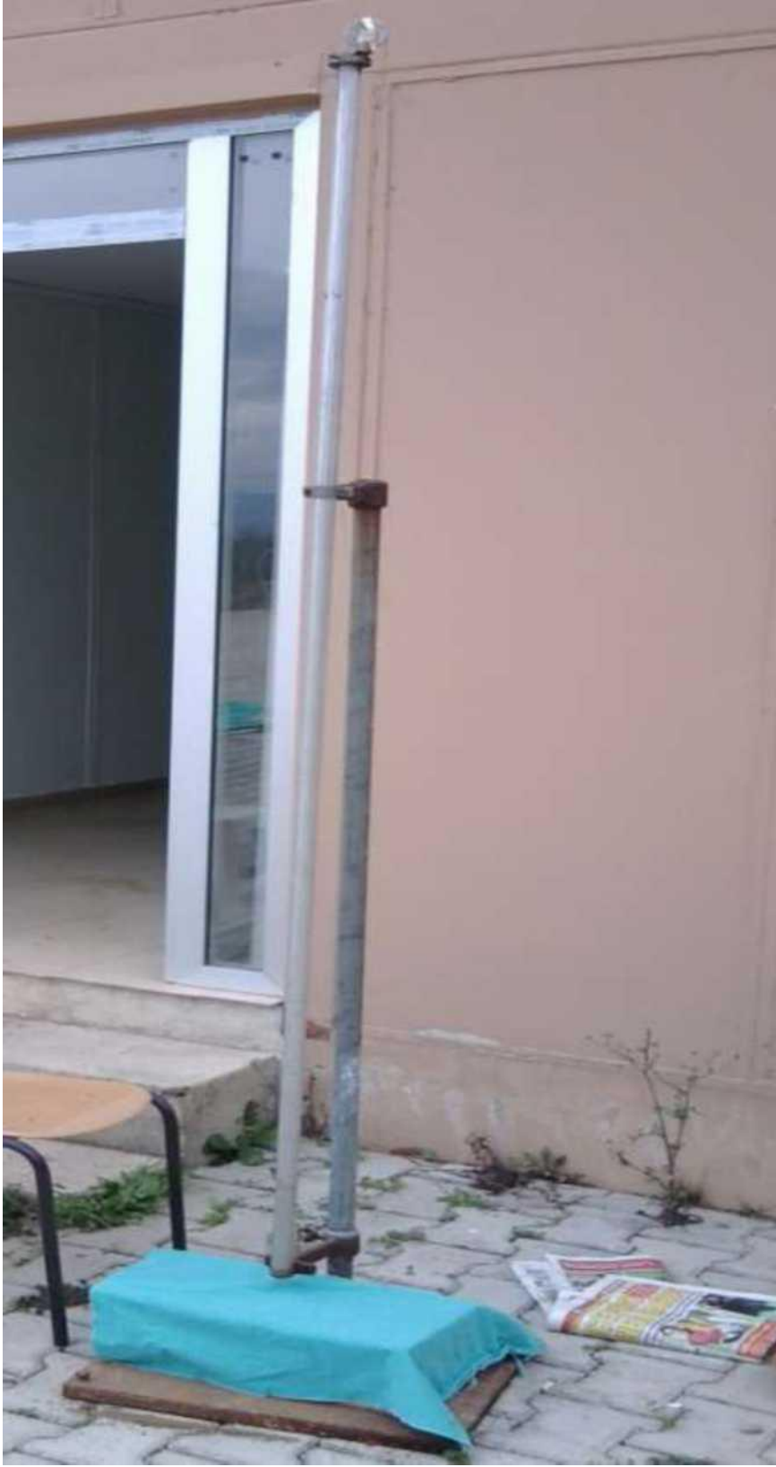
Resim-2: Marmarou ve ark. tarafından tarif edilen akselerasyon (yüksekten ağırlık düşürme) travma modeli.
