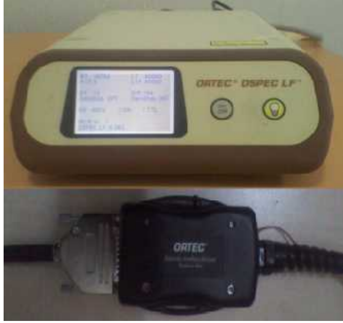
Şekil 3.7. DSPEC LF modülü (üstte) ve yüksek gerilim modülü (altta)
