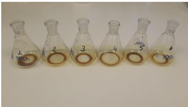
Resim 3.8. Suda çözünürlük tayininde hazırlanan örnekler
