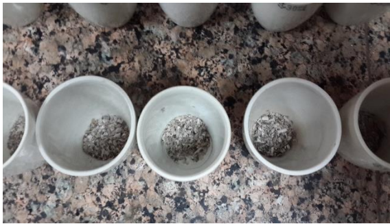
Resim 3.6. Mate örneklerinde bütün kül miktar tayininde krozelerin içinde kalan küller
