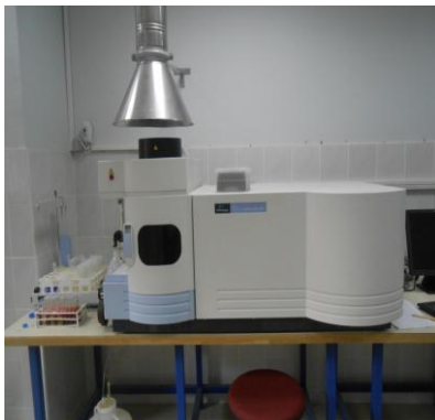
Perkin Elmer Optima 5300 DV Optik Emisyon(ICP)
