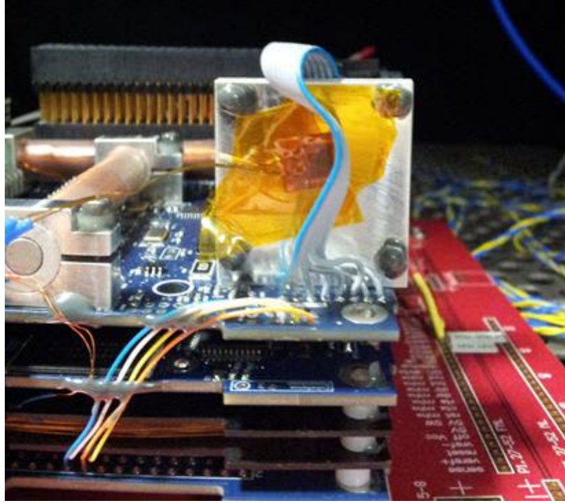
Şekil 4.4 : Teker üzerindeki sıcaklık ölçer.
