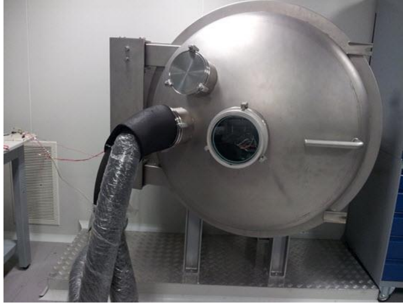
Şekil 4.1 : TVAC içerisindeki ADCS test öncesi.
