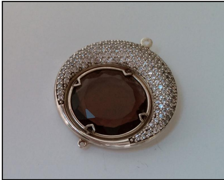
Şekil 137. Hilale mihlanan pırlanta kesim zirkon taşlar
