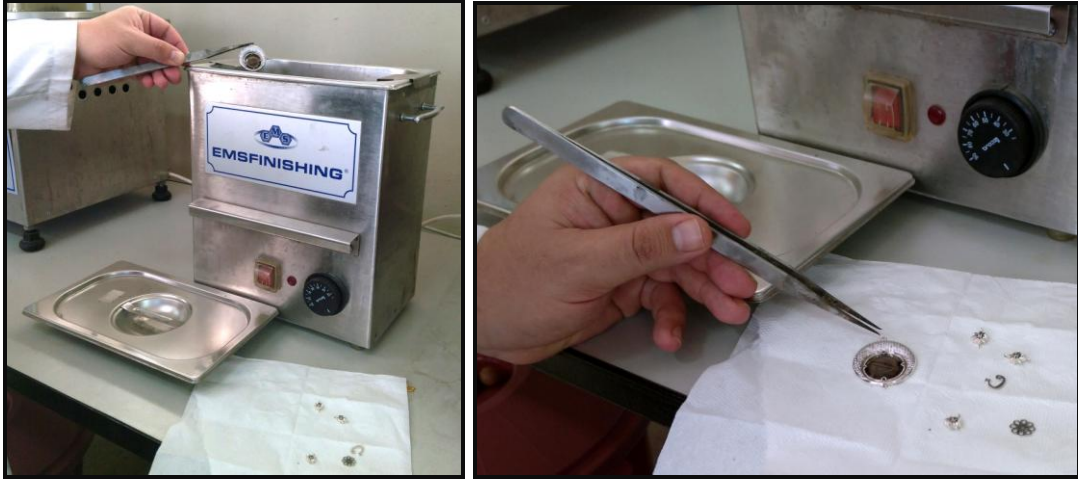
Şekil 140. Yıkama işlemi ve yıkanan kolye parçaları
