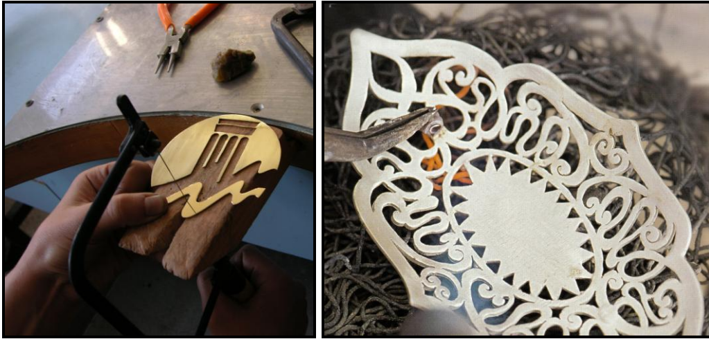
Şekil 41. Ajur tekniği ve bu teknikle kesilmiş bir parça
