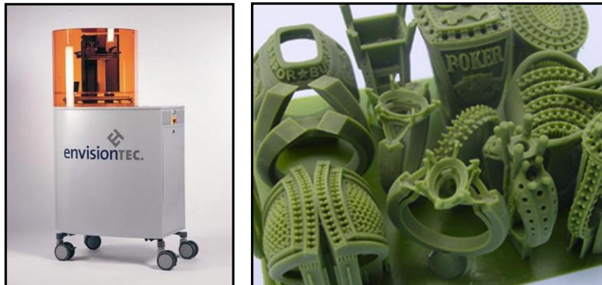
Şekil 56. Envision Tec makinesi ve bu makineyle üretilen mum kalıplar
