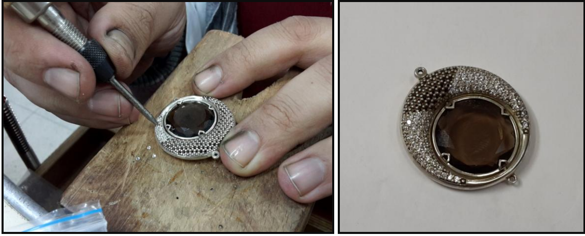
Şekil 136. Mihlama işlemi ve hilale mihlanan pırlanta kesim zirkonlar
