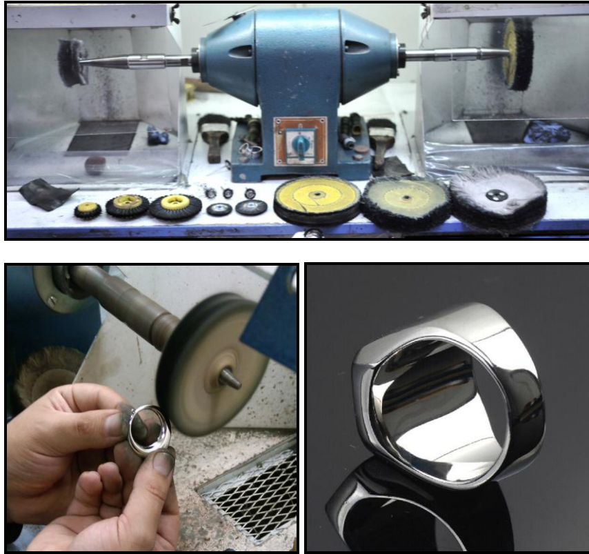
Şekil 37. Cila işlemi ve tesviyesi yapılarak parlatılmış yüzük
