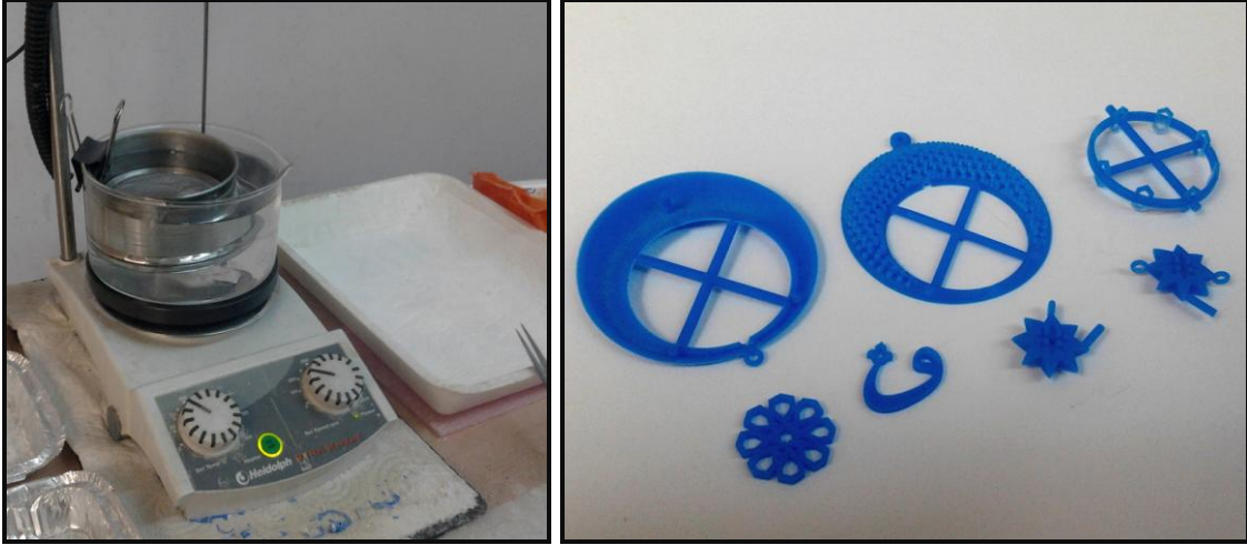
Şekil 126. Mum yıkama makinesi ve üretilecek kolye parçalarının mum kalıpları
