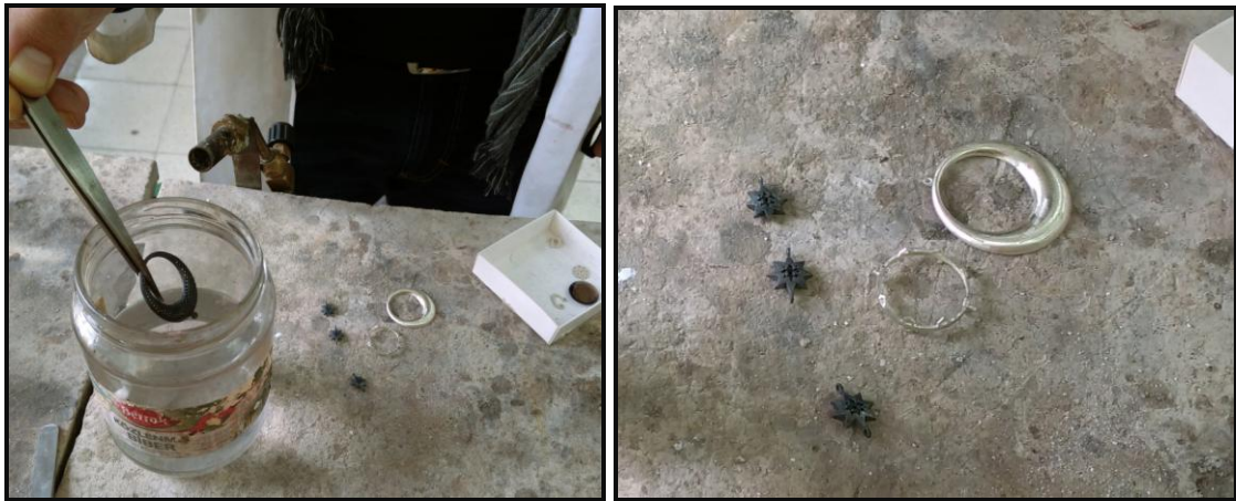
Şekil 129. Karartma işlemi ve karartılan kolye parçaları
