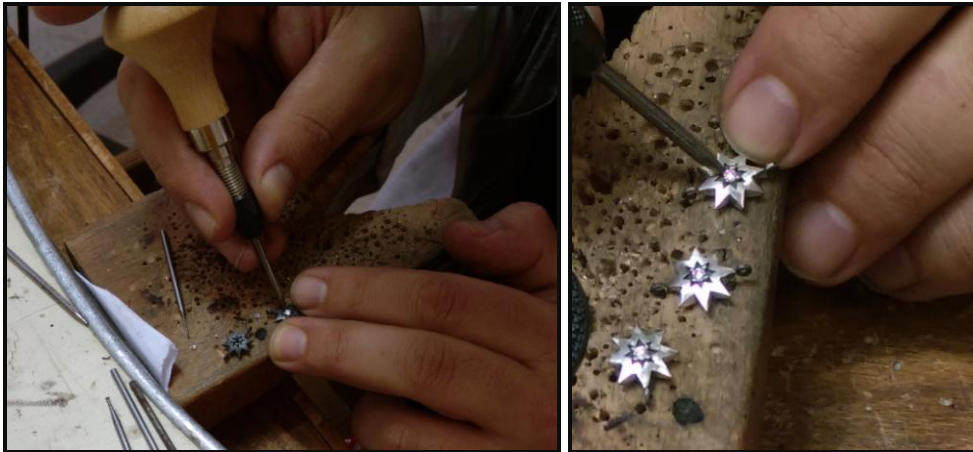
Şekil 135. Mıhlama işlemi ve yıldızlara mıhlanan pırlanta kesim zirkonlar
