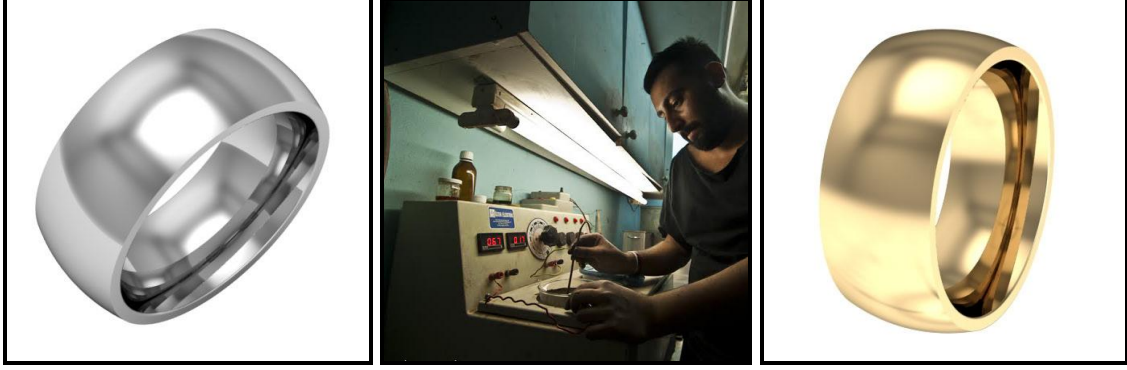
Şekil 34. Kaplama işlemi ve altın kaplanan gümüş alyans
