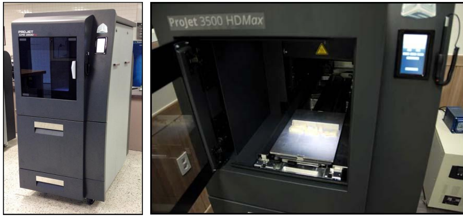
Şekil 124. Mum kalıp alınacak Projet 3500 CPX makinesi ve çalışma alanı
