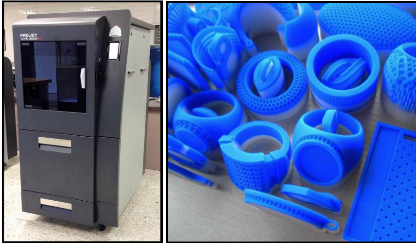
Şekil 58. Projet 3500 CPX Plus makinesi ve bu makineyle üretilen mum kalıplar
