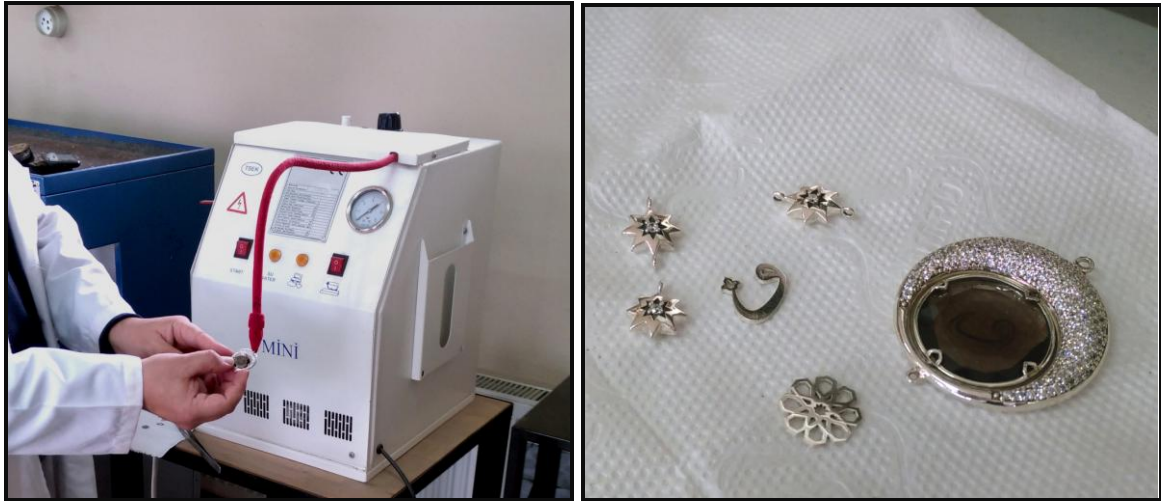
Şekil 141. İstim işlemi ve istim makinesi ile temizlenen kolye parçaları
