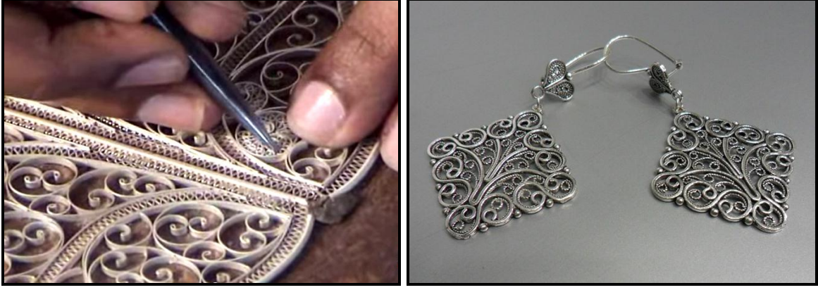
Şekil 44. Telkari işlemi ve bu işlemle yapılmış küpe
