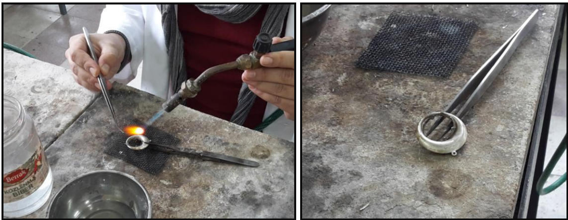
Şekil 131. Kaynak işlemi ve kaynak yapılan kolye parçaları
