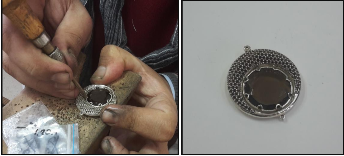
Şekil 134. Mıhlama işlemi ve mıhlanan dumanlı kuvars
