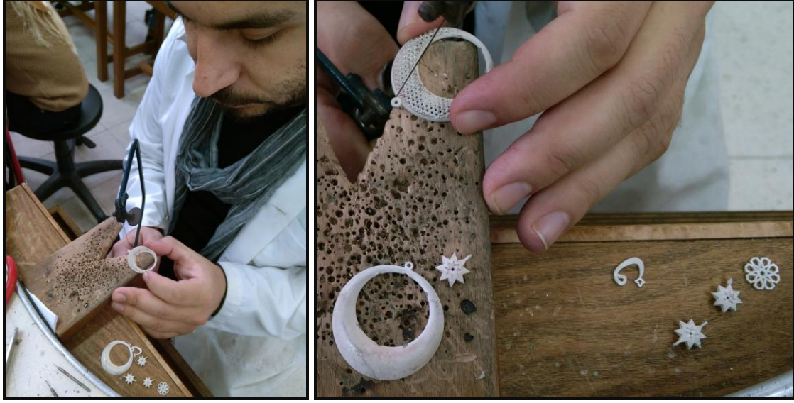
Şekil 128. Kesim işlemi ve yollukları kesilen kolye parçaları
