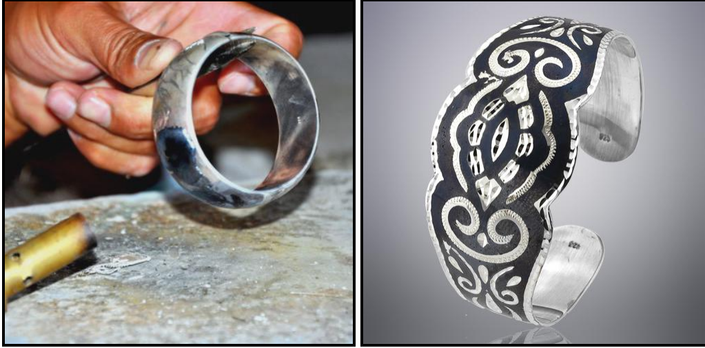
Şekil 43. Savatlama işlemi ve bu işlem uygulanan bilezik
