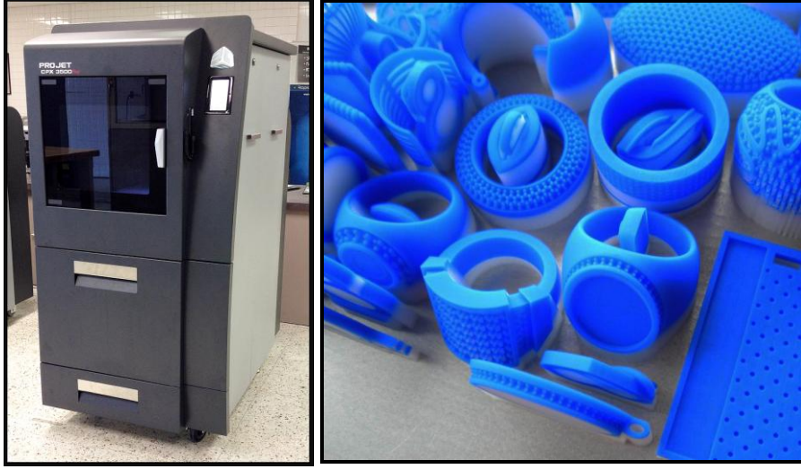
Şekil 69. Projec 3500 CPX Plus makinesi ve bu makineyle üretilen mum kalıplar
