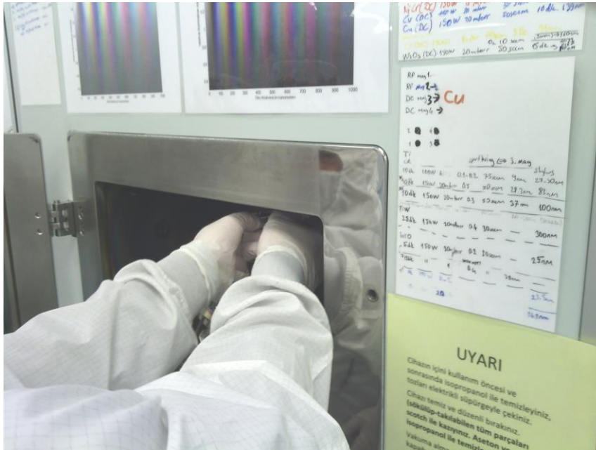
Resim 3.5. n-6H-SiC yarıiletkeninin metal buharlaştırma cihazına yerleştirilmesi
