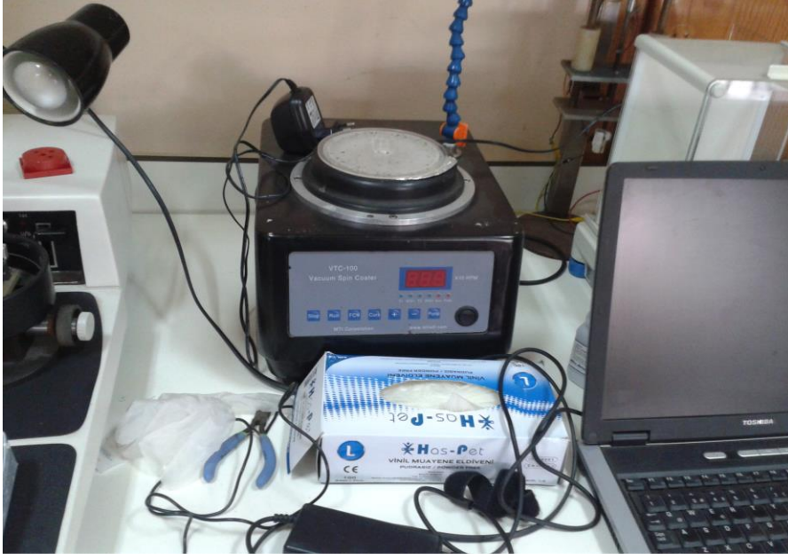
Resim 3.8. Numunelerin üretiminde kullanılan dönerli kaplama aygıtı
