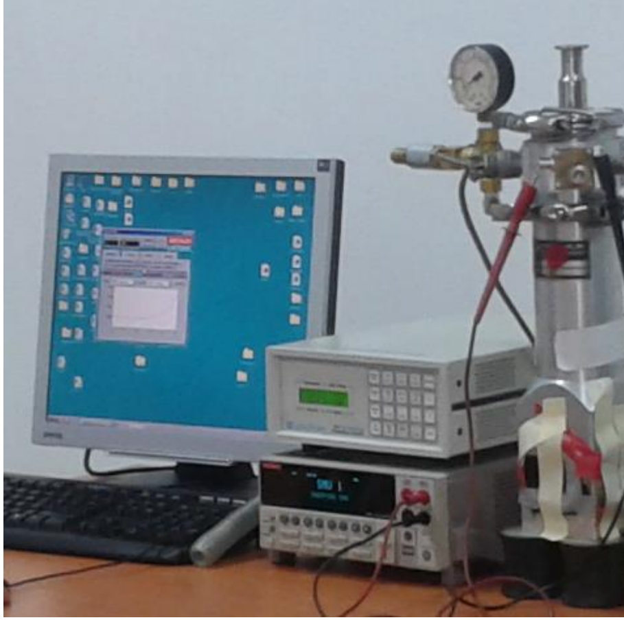
Resim 3.11. Akım-gerilim ölçümleri için kullanılan düzenek
