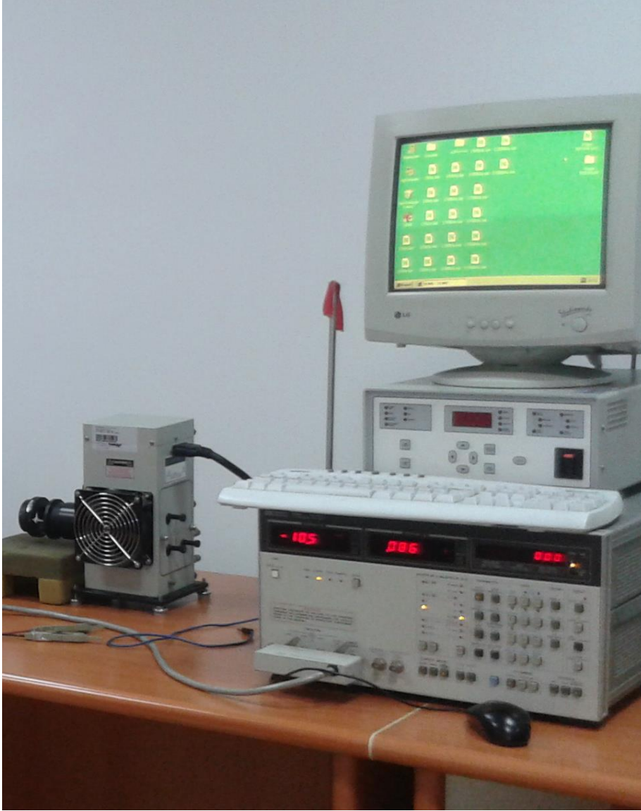
Resim 3.12. Kapasite-gerilim ölçümleri için kullanılan düzenek
