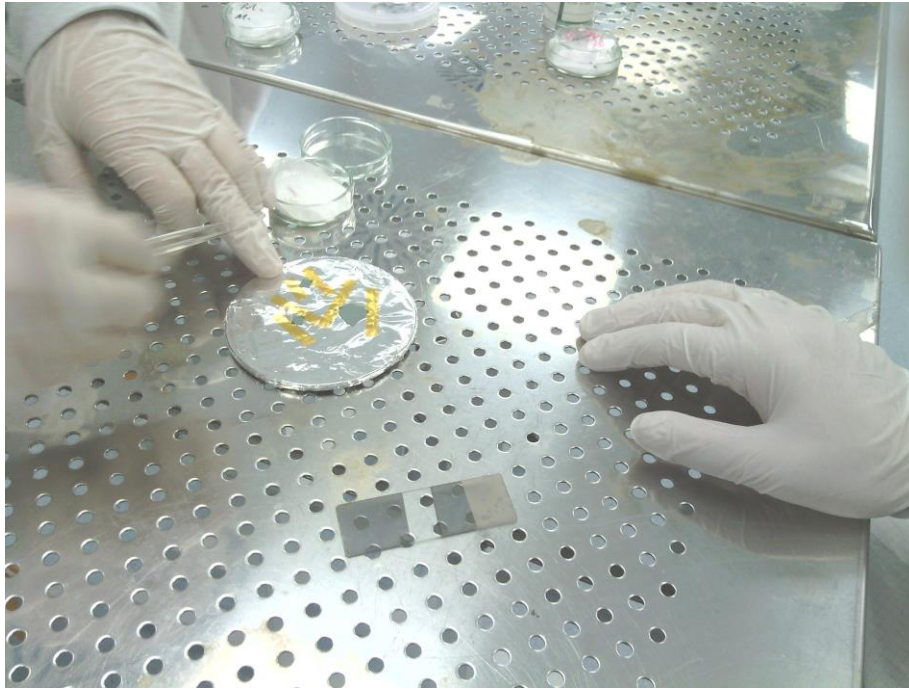
Resim 3.1. n-6H-SiC yarıiletken pulun numune oluşturmada önce uygun boyutlarda küçültülmesi
