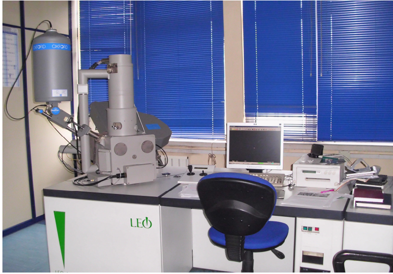
Şekil 3.28. Taramalı elektron mikroskopunun (SEM) fotoğrafı
