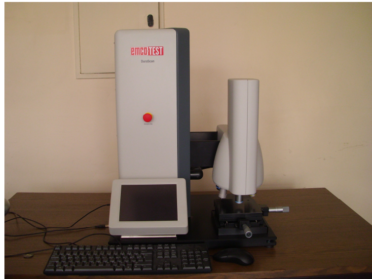
Şekil 3.30. Mikrosertlik ölçüm cihazının fotoğrafı.
