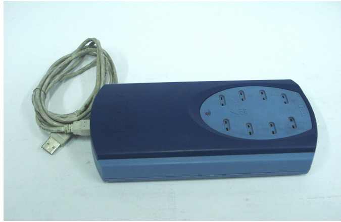
Şekil 3.15. Sıcaklık değişimlerinin kaydedilmesinde kullanılan Pico TC-08 model sıcaklık kaydedicisi.
