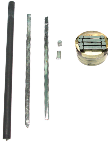
Şekil 3.20. Numune kalıbının oluşturulmasından epoksi-resin ile kalıplanması sürecine kadar ki herbir aşamanın gösterimi.
