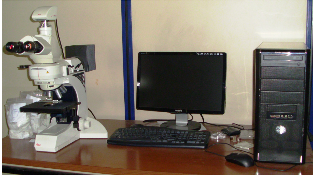
Şekil 3.27. Optik mikroskop ve CCD kameradan oluşan görüntü sistemi.
