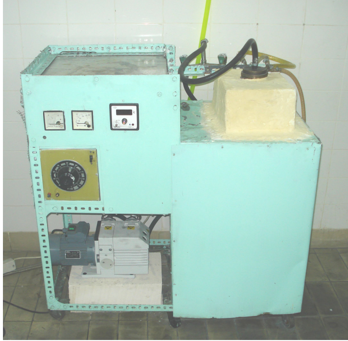
Şekil 3.1. Vakumlu eritme fırınının fotoğrafı.
