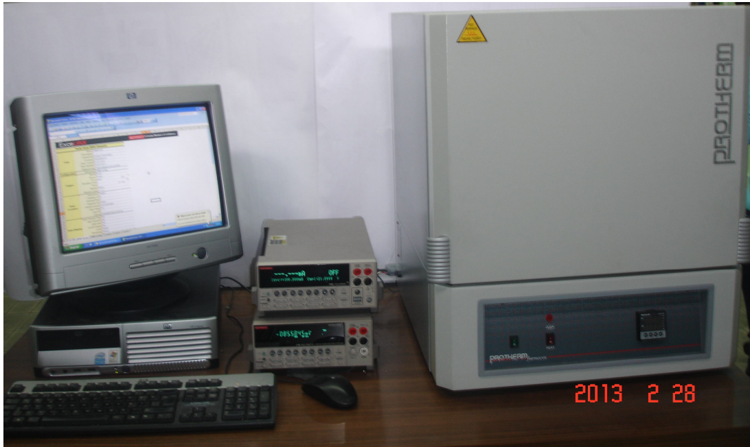
Şekil 3.32. Elektriksel iletkenlik ölçümünde kullanılan düzenek fotoğrafı.
