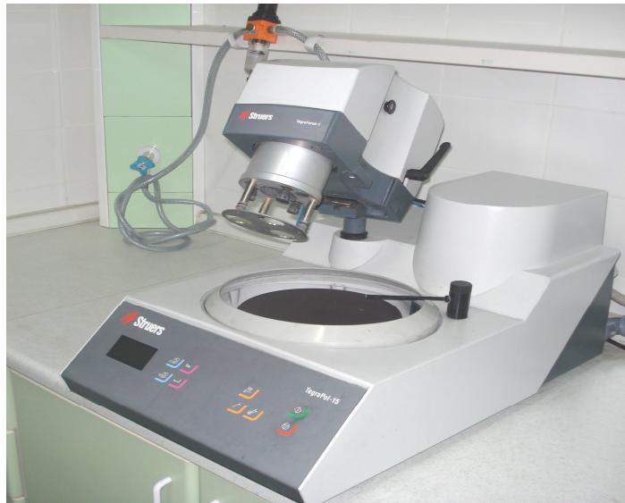
Şekil 3.24. Otomatik parlatma robotu.
