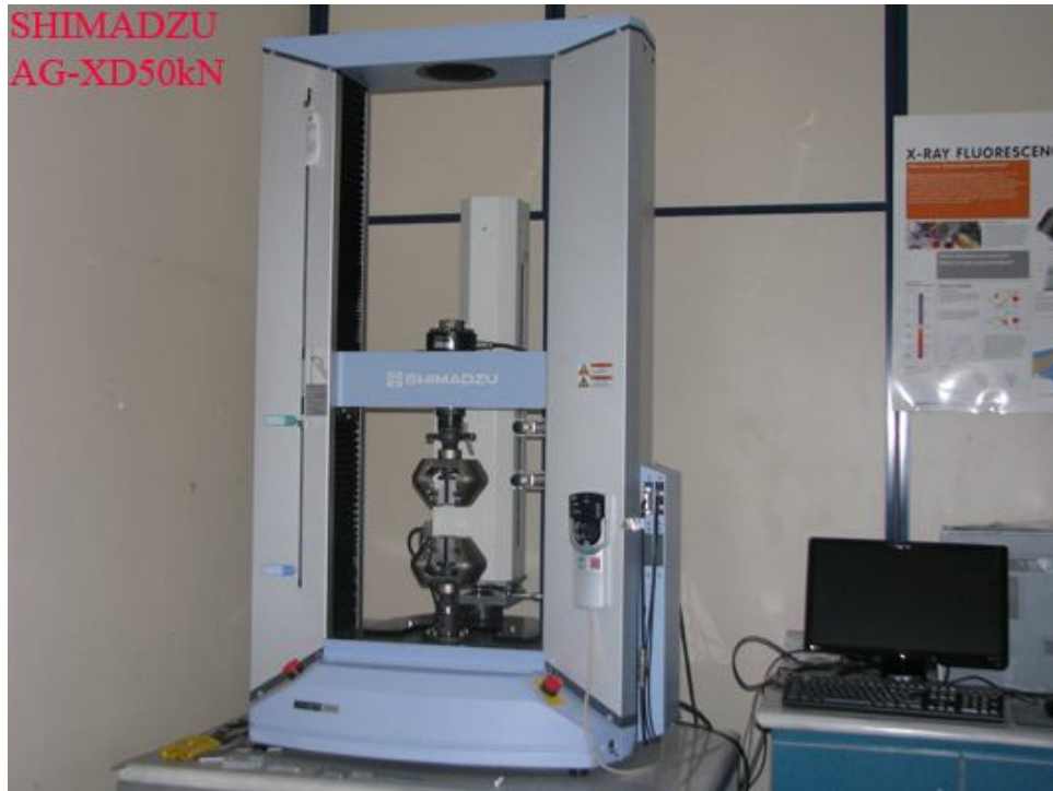
Şekil 3.31. Çekme-dayanım ölçüm cihazının fotoğrafı.
