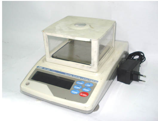
Şekil 3.11. Alaşım metallerinin tartılmasında kullanılan hassas terazi.
