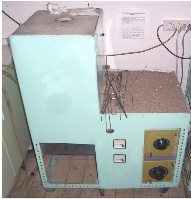
Şekil 3.3. Döküm fırınının fotoğrafı.
