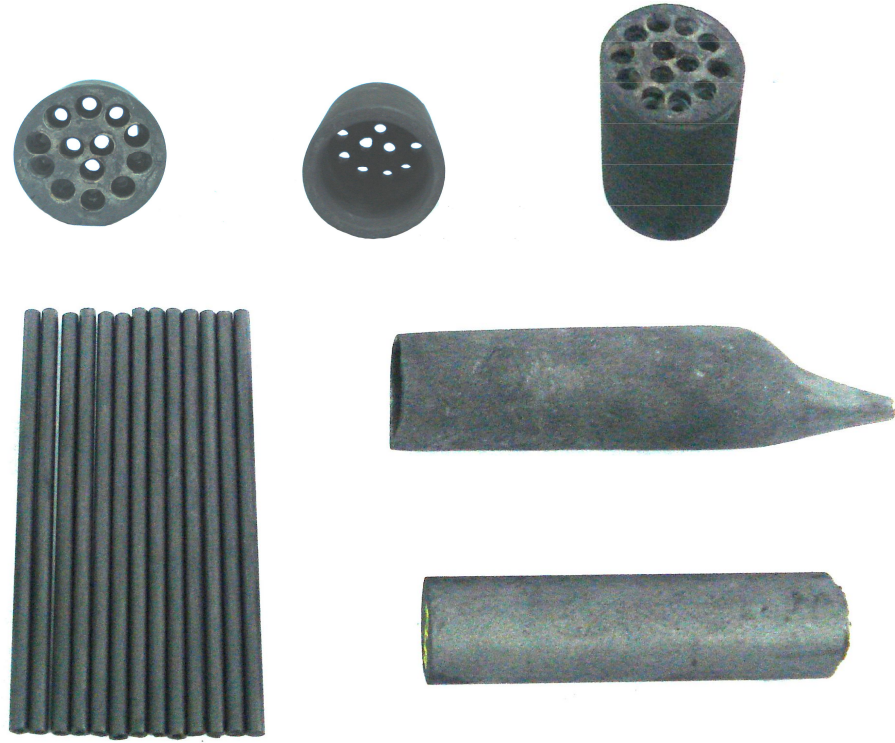
Şekil 3.9. Deneylerde kullanılan grafit numune kalıpları ve potaları.
