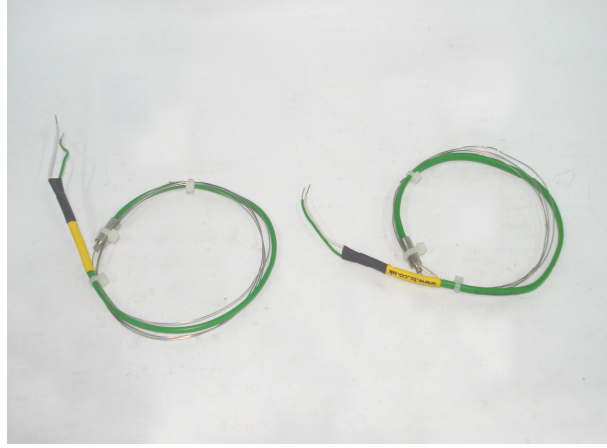
Şekil 3.14. Numunelerin sıcaklıklarının ölçümünde kullanılan K-tipi termal çiftler.
