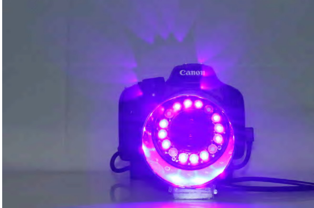
Şekil 3.14. QLF Görüntü alırken oluşan mavi ışık.
